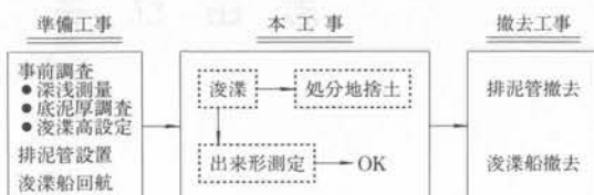
図-7 施工フローシート
