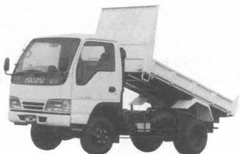
写真—4 いすゞ「エルフ」2t積み4WDダンプトラック
