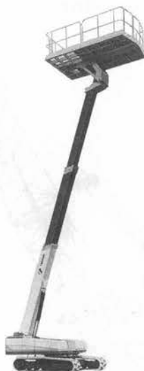
写真-8 タダノ AC-125 S スーパーデッキ
