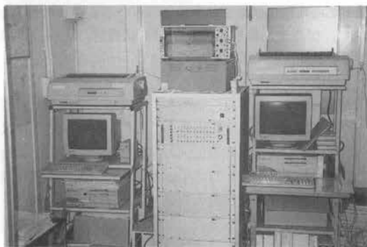
写真-3 鉄道躯体変形計測用機器
