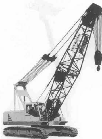
写真—7 日立 CX 500 全油圧式クローラクレーン
