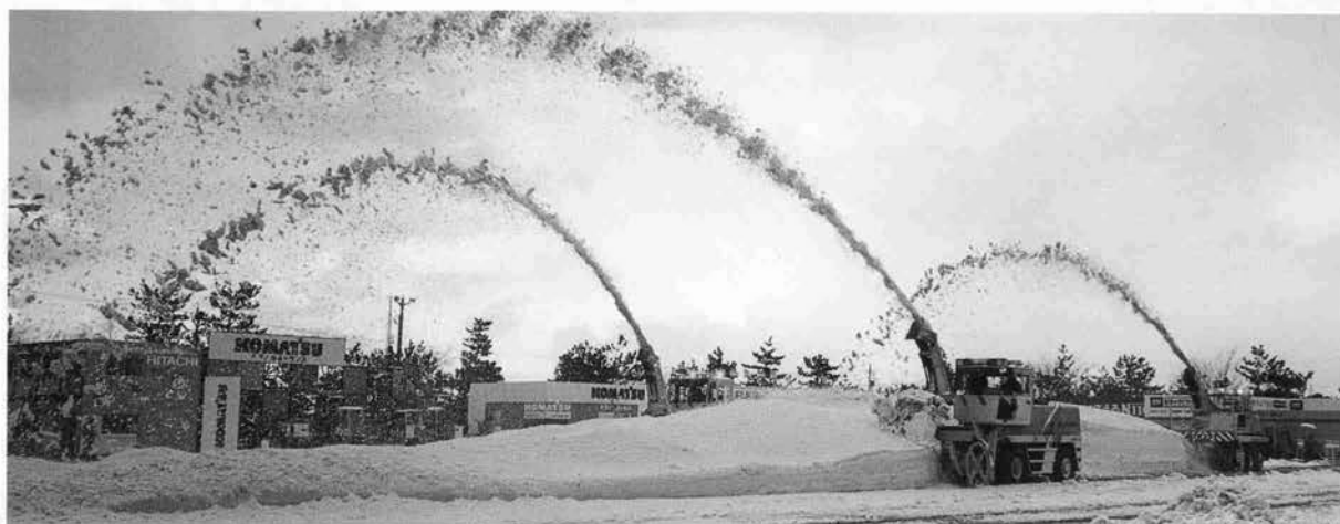
ロータリ除雪車による「すべり台」取壊し作業
