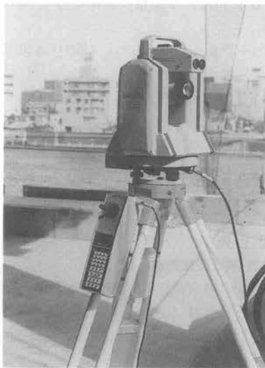
写真1 3次元自動測量システム (モータセオドライトと光波測距儀)
