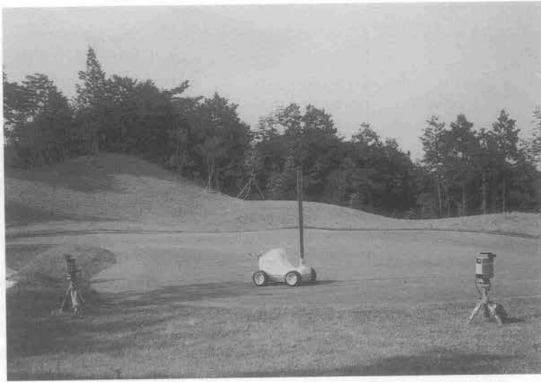
写真—1 グリーンアンジュレーション計測システム（レーザ灯台、測定車）
