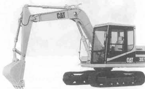
写真2 CAT 307 「REGA」油圧ショベル
