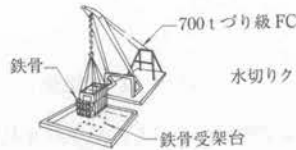
STEP-1 主塔基部鉄骨の架設
