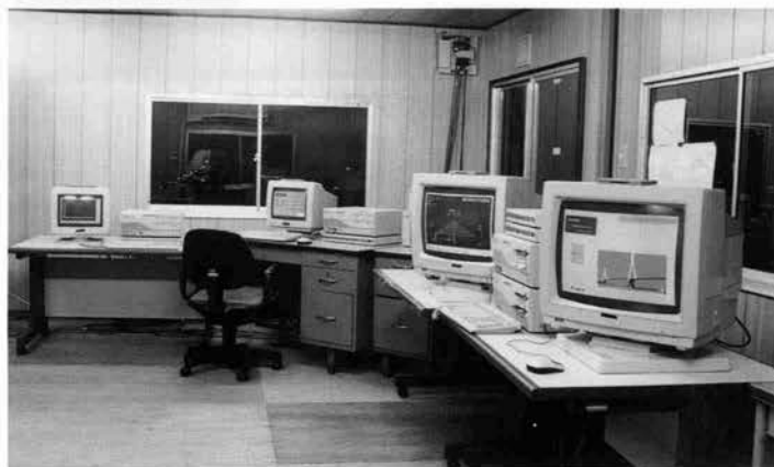
桁架設時形状管理用計測室
