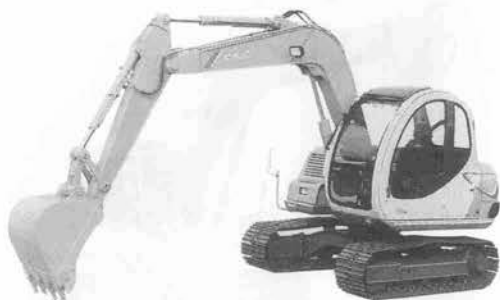
写真-2 神鋼アセラ・スーパーバージョンSK 60油圧ショベル
