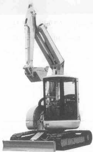
写真-1 神鋼SK 50 UR 車幅内旋回ショベル
