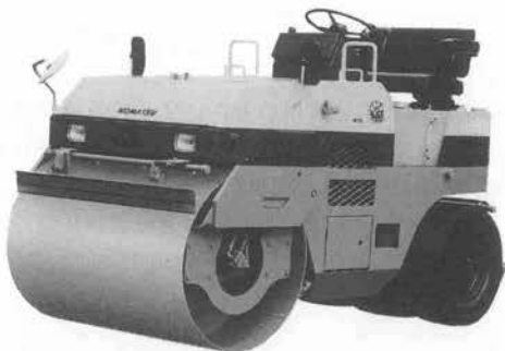
写真-9 KOMATSU JV 25 CR -6 リジッド式コンバインドローラ
