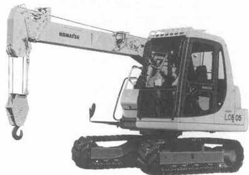
写真-5 KOMATSU LC 605-2 クローラクレーン
