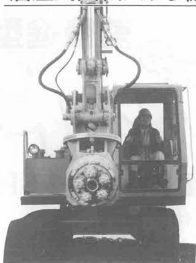
取付重機0.25m 3 以上
