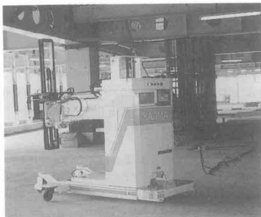
写真-9 カーテンウォール取付アタッチメント
