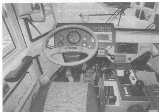
写真-2 高速走行型ロータリ除雪車の運転席
