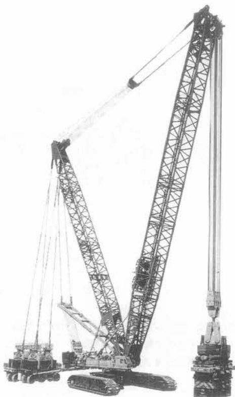
写真一 SL-13000 800tつりクローラクレーン
