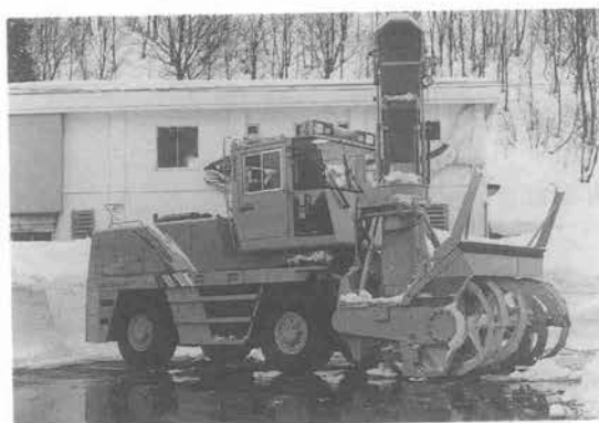
写真-1 高速走行型ロータリ除雪車の全景
