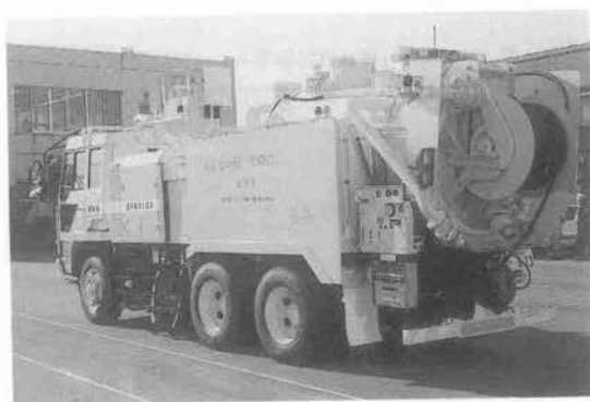
写真一7 リサイクル式側溝清掃車
