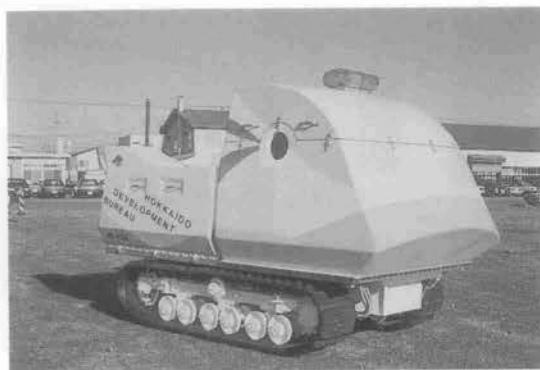
写真-3 半没水式ポンプ自走装置
