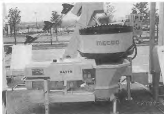
写真9 簡易吹付プラント (MECBO 社, オーストリア) 砂を搬送する、むき出しのバケットコンベヤとミキサおよびかなり小さなコンクリートポンプが組合せられており、セメントはミキサ上部で投入される。計量装置がないためかなりコンパクトにできている (容積計量)。
