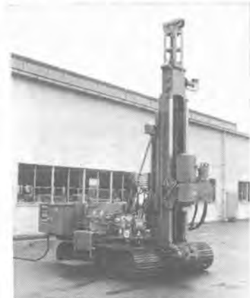
YBM-SS-60地盤改良機
