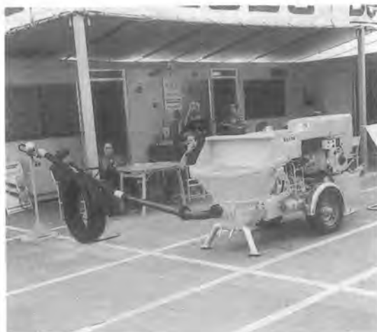
写真10 コンクリートポンプ (MECBO 社, オーストリア) 吐出口径3"をテーパ管で2"に落とし、濃密状態で圧送されるコンクリートをノズル部でエアと急結剤 (液状) を添加し吹付する。
