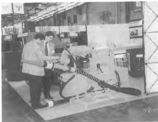
写真7 吹付ロボット (スイス) スライド運動、ノズル部の自動揺動する機能を持ち、バックホウ等に取付け、トンネル等に使用すること。
