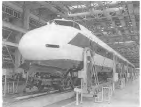
写真-5 台車振替作業(2両同時)
