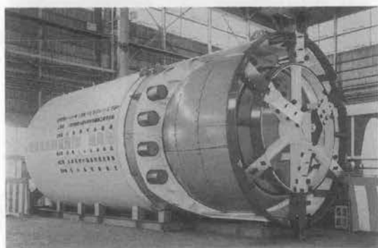
写真-2 鞘管引抜き完了状況 (製作時工場撮影)
