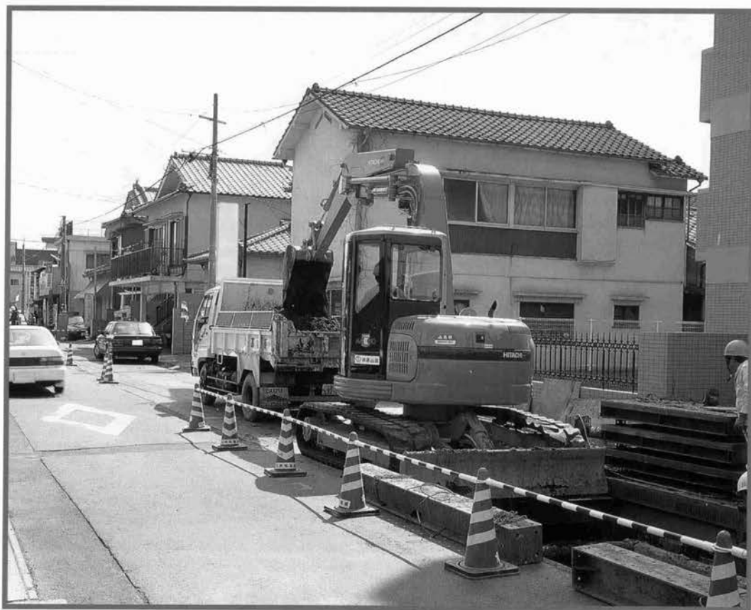
超小旋回型油圧ショベル Landy MARCCINO シリーズ 日立建機株式会社
