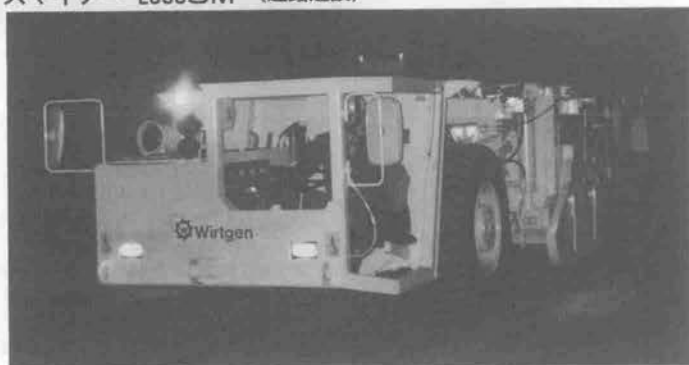
ティンテングマシン2600 (トンネルの床掘作業)
