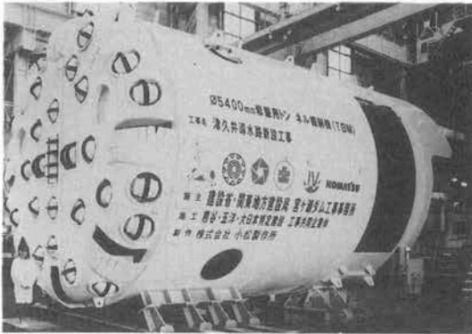
写真-1 工場で作成した TBM
