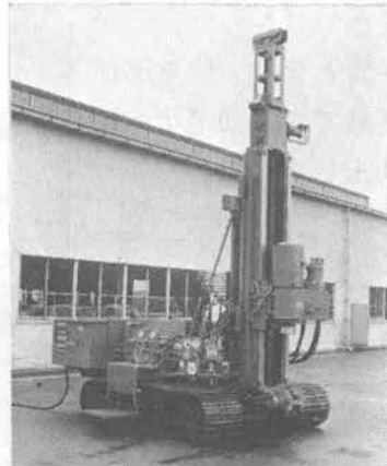
YBM-SS-60地盤改良機
