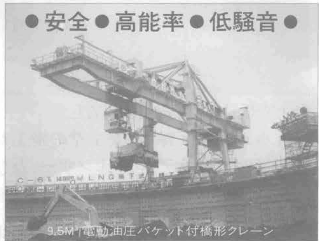
9.5M 2 電動油圧バケット付橋形クレーン YGMT-10H-400 巻上速度 70m/min 横行速度 70m/min 走行速度 8m/min
