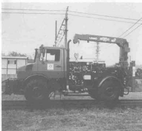
クレーン作業装置
