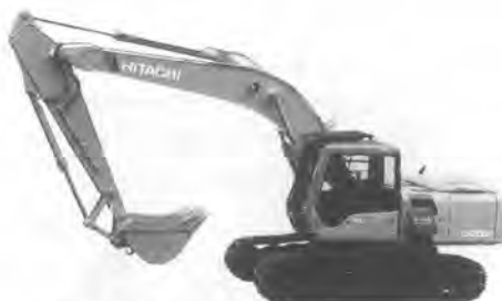
写真6 日立 EX 200 K 3 解体作業用油圧ショベル
