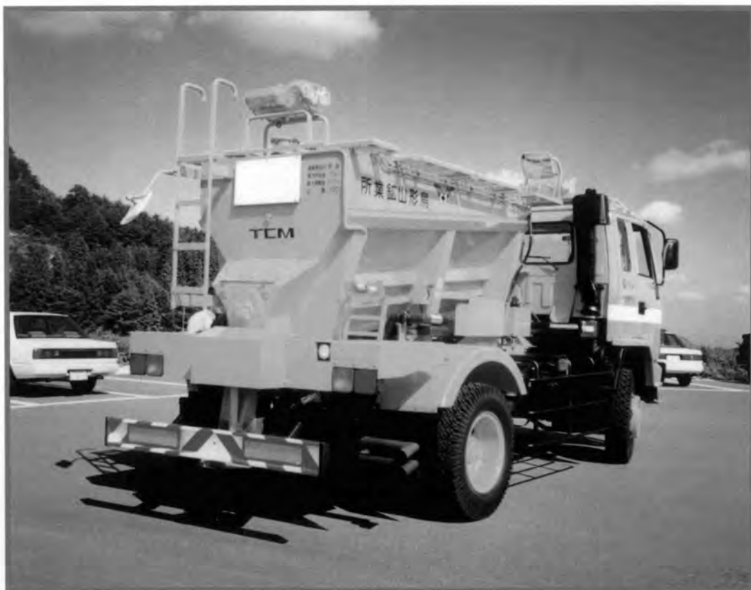
凍結防止剤散布車ESD25-2型 ホッパ蓋自動開閉装置付 4輪駆動仕様書 東洋運搬機株式会社
