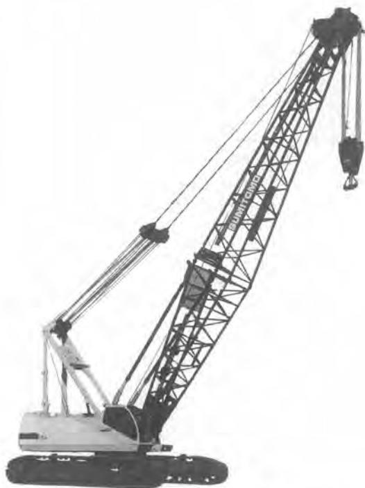
写真-12 住友パーク SC 1000-2 油圧式クローラクレーン
