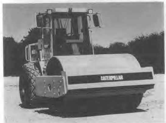
写真-14 CAT-CS-563 土工用振動ローラ
