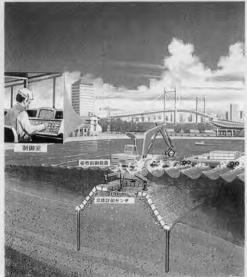
⇨ 浚渫工法の高効率のための技術
