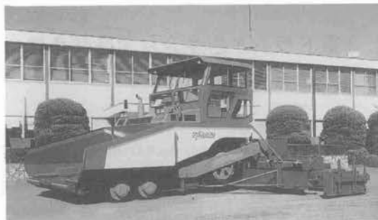
写真-17 新潟セントーレ 80 E アスファルトフィニッシャ
