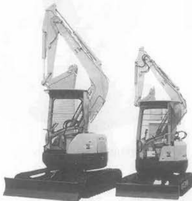
写真-4 日立 EX 55 UR (左)、EX 30 UR (右) 超小旋回型ミニショベル
