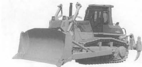
写真1 コマツ D 155 AX 3 Super ブルドーザ
