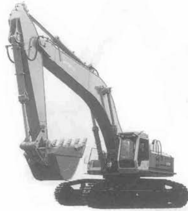
写真8 日立ニュー EX 700 油圧ショベル
