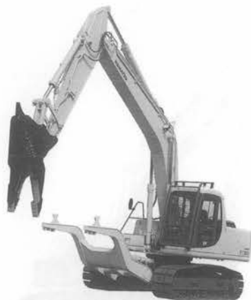
写真-9 コマツ PC 200 CS ハンドラ油圧ショベル (自動車解体専用機)
