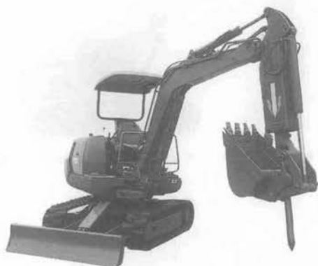
写真-3 コマツ PC 20 7 -アバンセ R ミニショベル (ブレーカ内蔵アーム仕様車)
