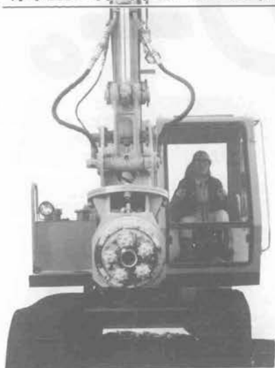
取付重機0.25m 2 以上
