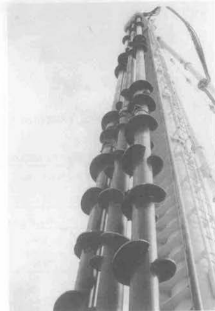
写真—3 三軸オーガロッド 回転翼が途中で切れているのが特徴である
