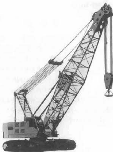
写真-5 神戸 BM 800 全油圧式クローラクレーン
