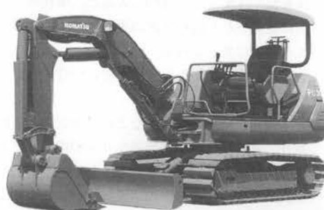
写真-2 コマツ PC 30 -7 ジオマスタ・油圧ショベル
