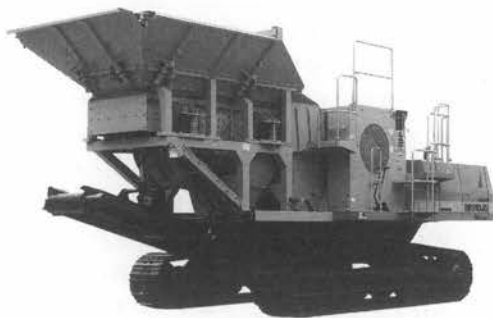
写真-7 BR 310 JG-1 ガラバゴス振動グリズリフィーダ搭載機
