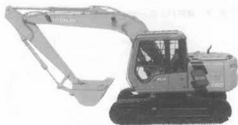
写真-3 日立 EX 120-3C 排出ガス対策型油圧ショベル
