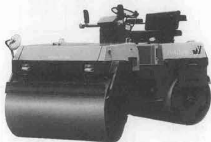
写真-8(2) コマツ JV 40 DW-3 振動ローラ
