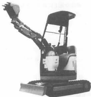
写真-1 コマツ PC 08 UU 深礎仕様電動式油圧ショベル
