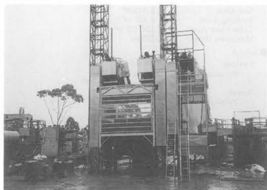
写真-2 4tエレベータ荷重試験状況 (右側は調整中の2tエレベータ)
