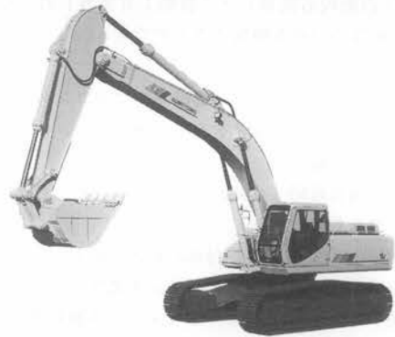
写真-2 住友 SH 450 LHD 重掘削タイプ油圧ショベル
