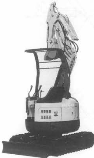
写真-1 日立ランディマルチーノ EX 15UR 超小旋回型ミニショベル
