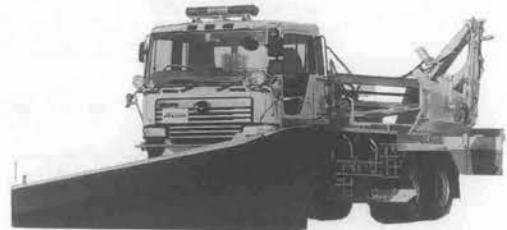
写真-9 日野スーパードルフィンプロフィア KC-FU 4 FPDA 改 (6×6) 除雪車
