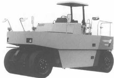
写真-2 トルクコン付タイヤローラ TS600C
