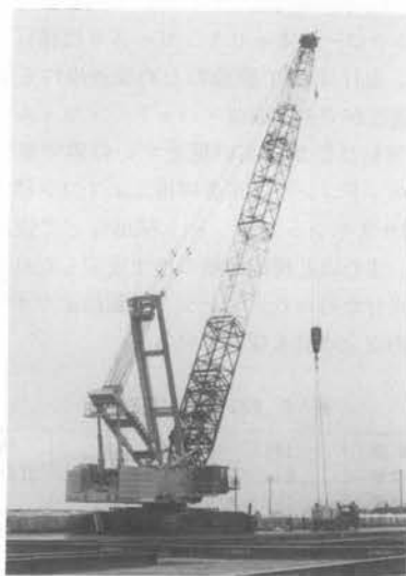
写真-6 住友 CT 12000 全油圧式超大型クローラクレーン
