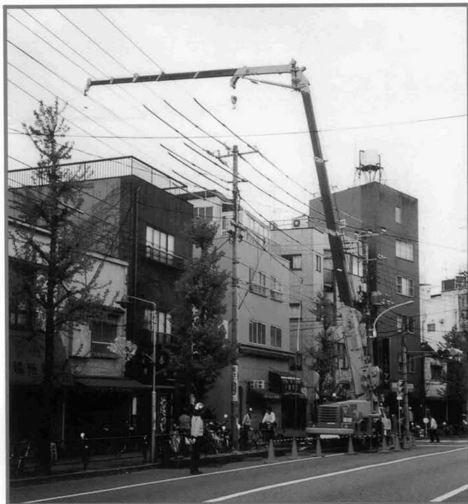
ホイールクレーン「リーチタワークレーン LT300-1『ピタゴラス』」 コマツ
