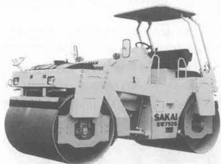
写真—3 振動ローラ SW750
