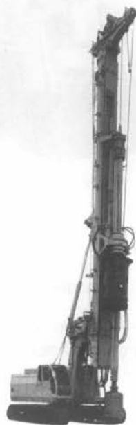
写真-7 住友ソイルメック SD 415 アースドリル
