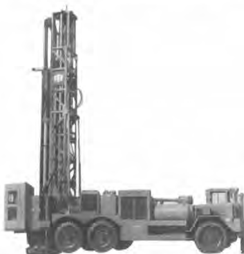
図-20 ダウンザホールドリル
