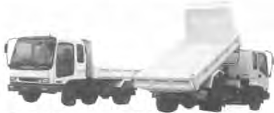
写真-5 いすゞフォワード KC-FRR 33 D 2 D (210 PS) ダンプトラック
