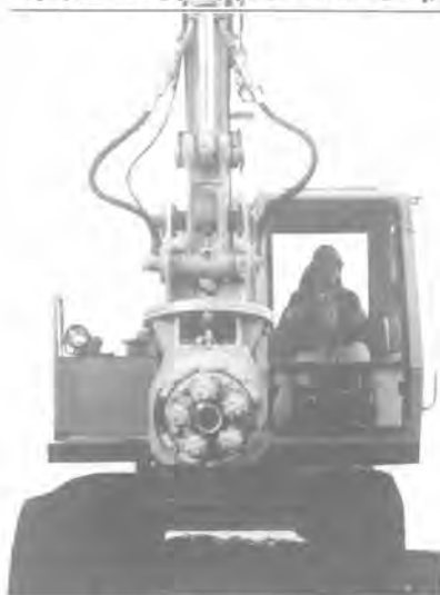
取付重機0.25㎡以上
