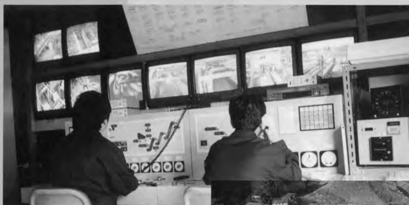
⇨連続掘削システム集中管理室
