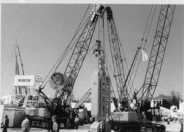
◀ 地下連続壁掘削機
