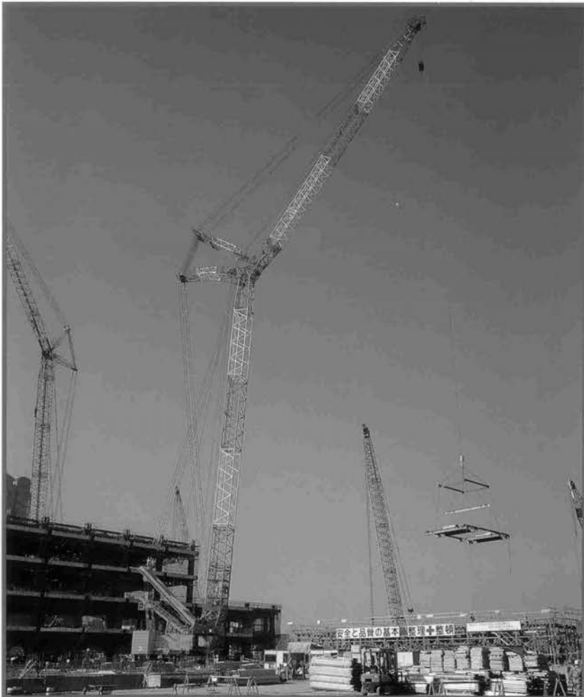
全油圧式超大型クローラクレーン CT12000 住友建機株式会社
