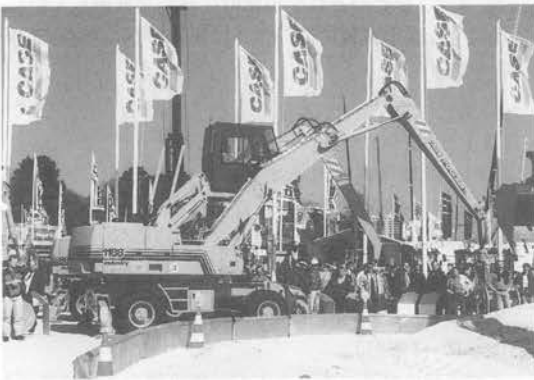
写真一八 ロングブームでハイキャブ仕様のホイール式油圧ショベル
