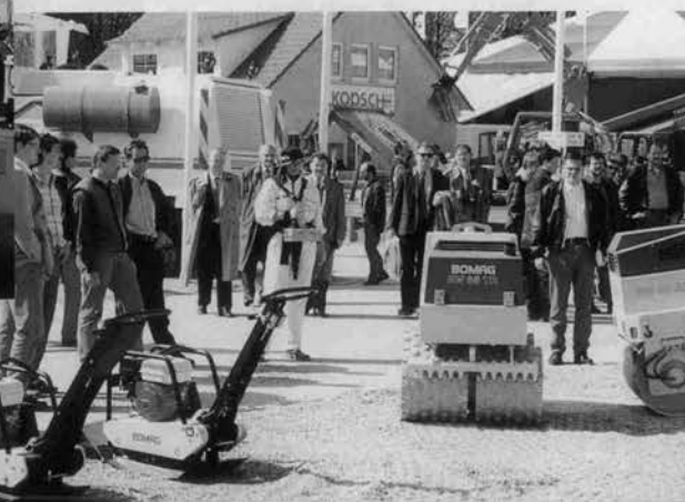
⇨ BOMAG社のラジコン操作によるコンパクター
