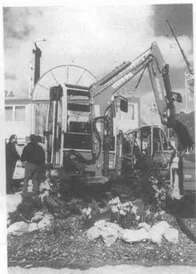
写真-11 キャブレベラにより水平状態で作業可能
