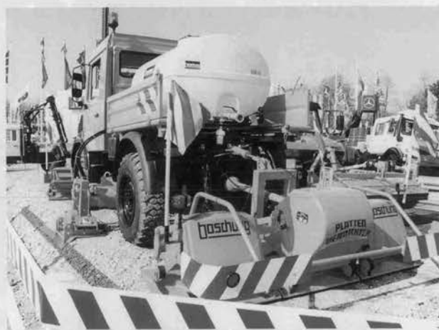
⇨ アスファルト敷設などの万能車
