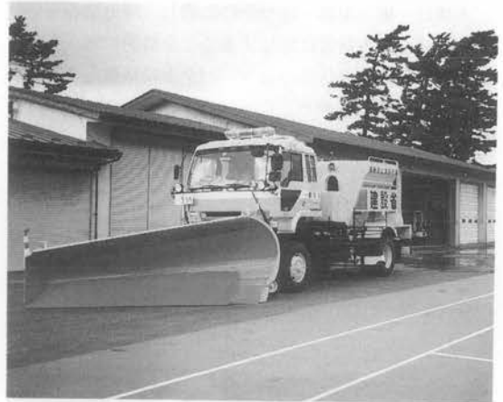
写真-8 除雪トラック (10t級 4×4)
