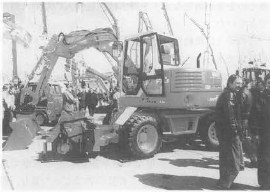
写真一七 ツーピースブームのホイール式油圧ショベル。各種の作業に対応する様々なアタッチメントが装着可能な工夫をしている
