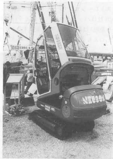
写真一〇 キャブがチルトして整備性を良くしている
