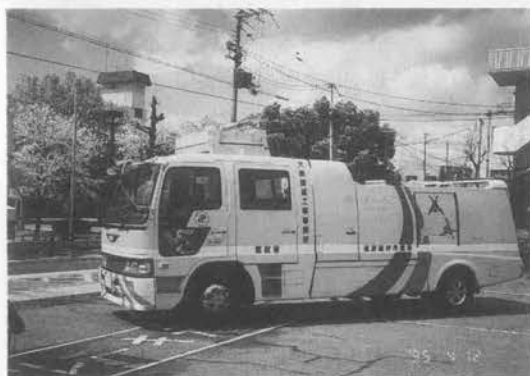
写真-2 作業車(ハイブリッド式)
