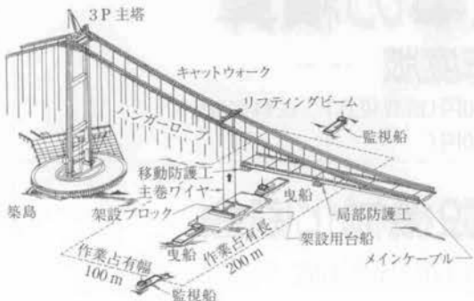
図-10 直下つり架設概要図
