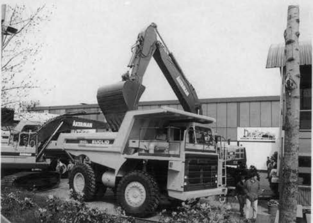
◀ EUCLID社ダンプトラックR40とAKERMAN社 油圧ショベルEC650の組合せ
