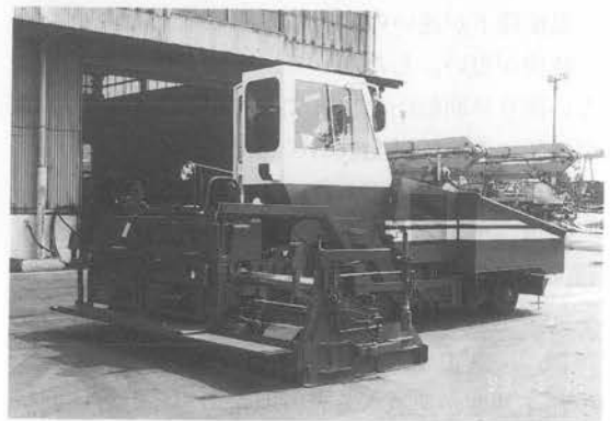
写真-2 温度調整機能付き熱風加熱式スクリードを装備したアスファルトフィニッシャ
