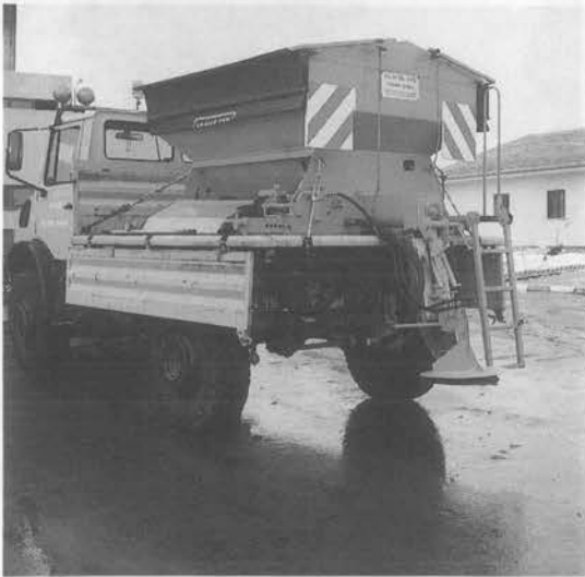
写真—11 凍結防止のドイツ製の塩散布車（セリンバシャ管理事務所）
