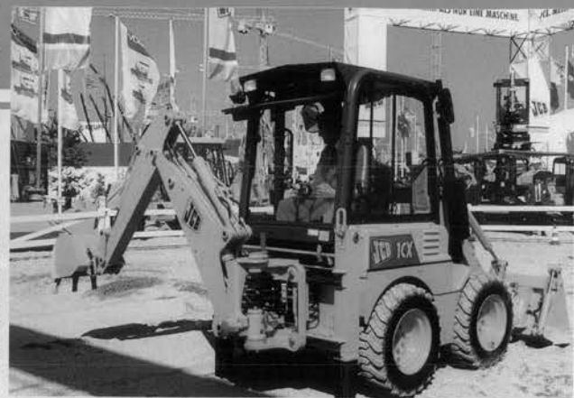
⇨JCB社のスキッドステア機能を持つバック ホーローダ
