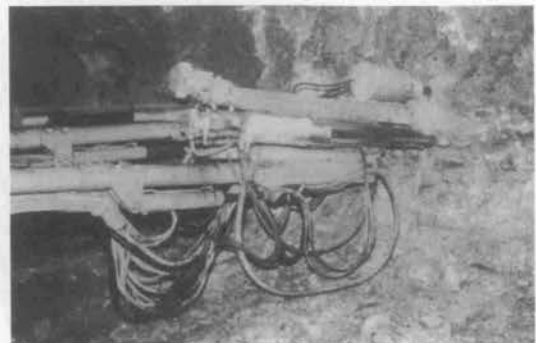
アイオワ州リンウッド (Linwood) 石灰鉱山で稼働中のジャンボのブームに取付けられたドリルと 75 mm 径の破碎機
