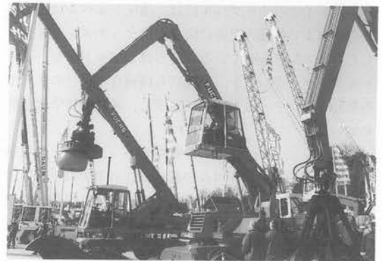
写真一八 マグネット装着でキャブ高さを自在に調整可能な解体仕様油圧ショベル
