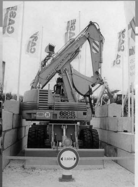
⇨ CASE688B(スライドブームにしてコンパクトにしている)
