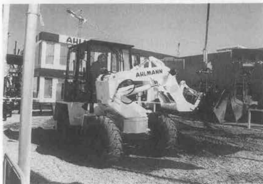
写真—5 作業機が90度旋回するAhlmann社のホイールローダのデモ
