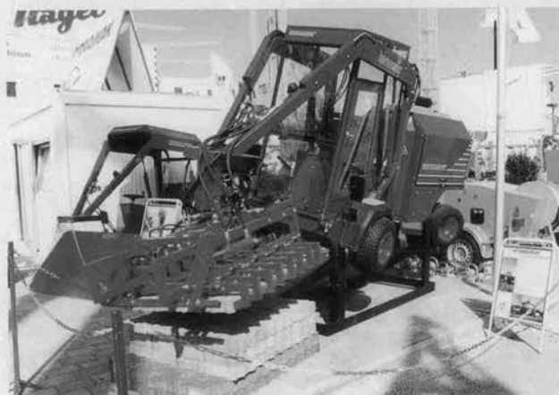
◀ 路面ブロック敷設自動機械
