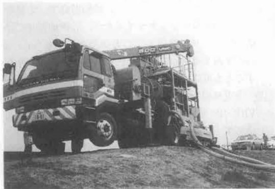
写真-1 作業車(堤脚水路清掃車)
