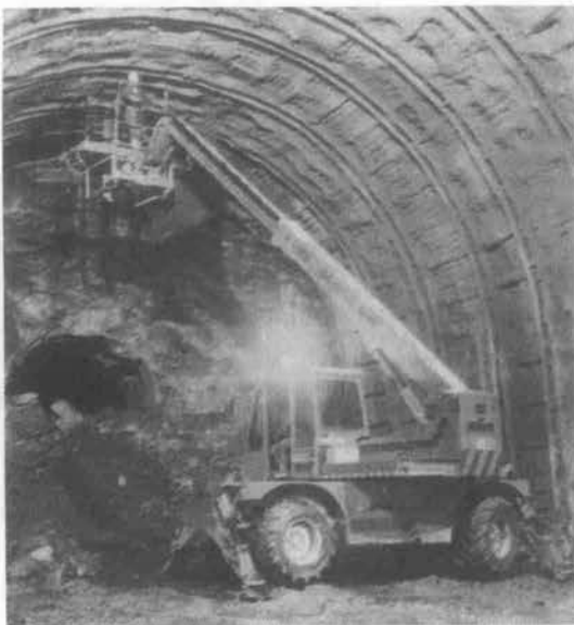
アイオワ州リンウッド (Linwood) 石灰鉱山で稼働中のジャンボのブームに取付けられたドリルと 75 mm 径の破碎機
