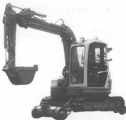
写真—6 コマツ・スーパーライナ PC 50 UUT-2 NA 軌陸式作業車
