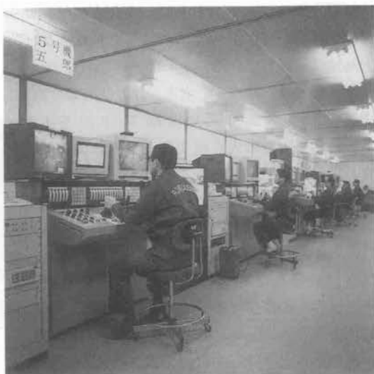
写真1 中央管理室での地上遠隔操縦掘削状況
