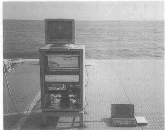
写真-1 ケーソン据付け管理装置
