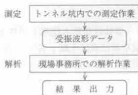
図-2 TSP システムでの作業手順
