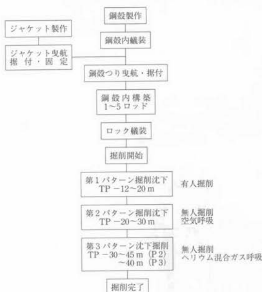
図-5 掘削沈下の流れ
