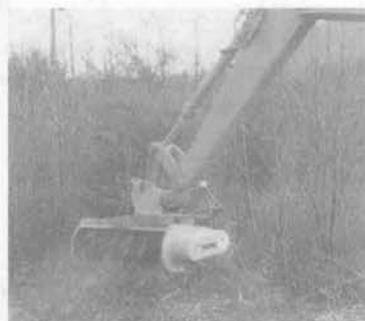
フレイルヘッドカッター 立木をそのままの形で処理する (ショベル装着用)
