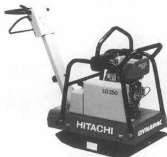
写真-13 日立 LG 250 ソイルコンパクト
