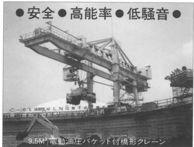
9.5M 3 電動油圧バケット付橋形クレーン YGMT-10H-400 巻上速度 70m/min 横行速度 70m/min 走行速度 8m/min
