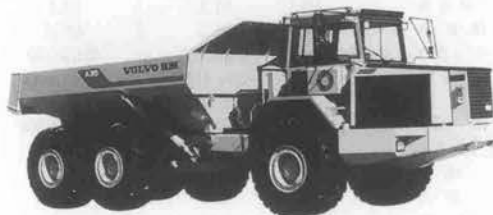
写真一7 日立・ボルボ A 35 アーティキュレートダンブトラック
