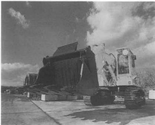
写真—14 電動式坑内積込み機
