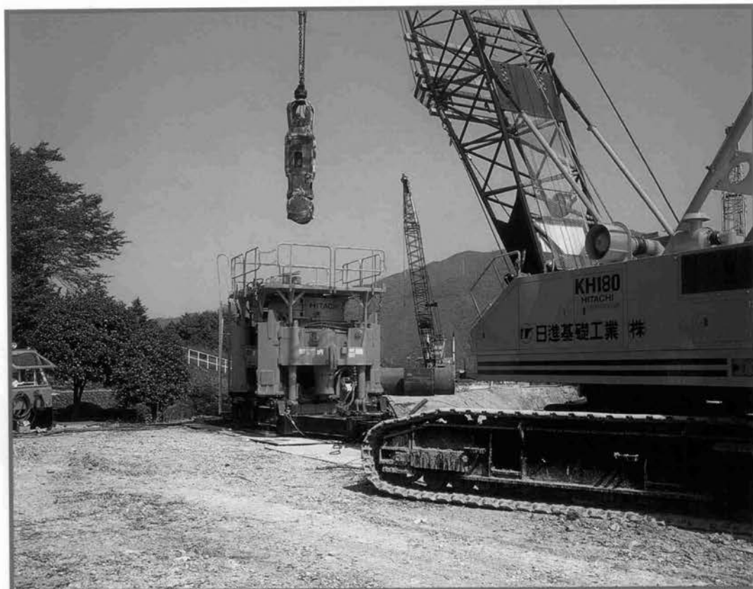
岩盤掘削施工用回転式ケーシングドライバ CD1500 日立建機株式会社
