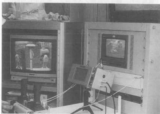
写真-2 TVモニターを見ながらの遠隔操作状況
