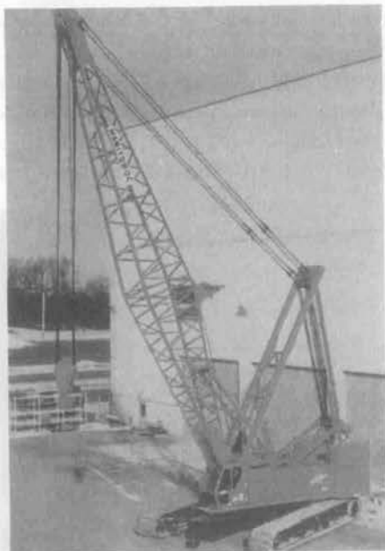
写真—2 新型 888 リフトクレーン用ラッピングジブと能力増大アタッチメント
