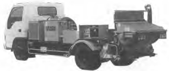
写真-9 新潟 NCP 3 T「Mc ミニ」コンクリートポンプ車
