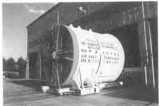
写真—4 φ4.66 泥土圧シールド機
