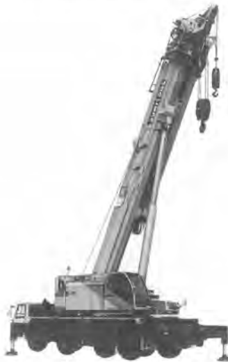
写真-8 住友 SA 1200 オールテレーンクレーン
