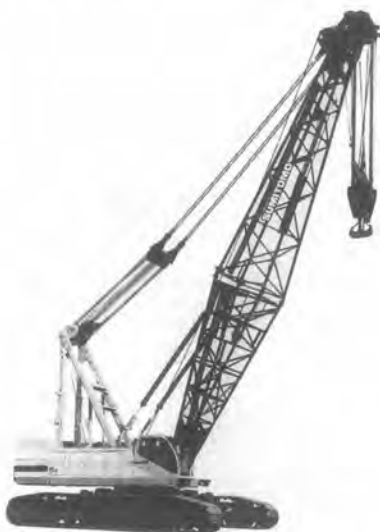
写真—7 住友 PAX SC1500-2 油圧式クローラクレーン
