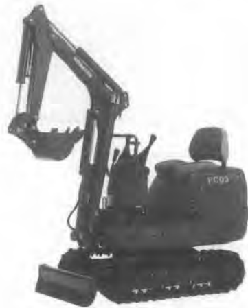
写真2 コマツ PC 03 -2 ディーゼルエンジン仕様マイクロショベル
