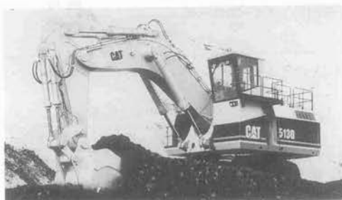
写真-4 CAT 5130 油圧ショベル
