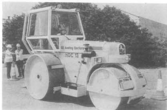
写真-2 Aveling Barford社の改良型ロードローラHDCシリーズ(12~15t)、全油圧制御
