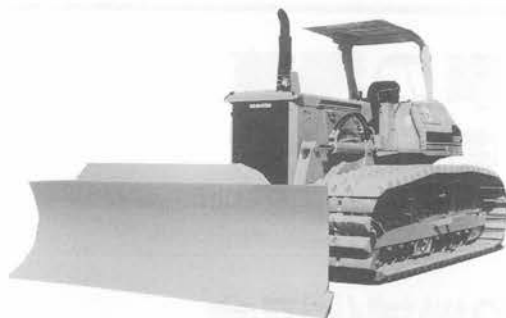
写真—1 コマツ D53P-18AE 湿地ブルドーザ
