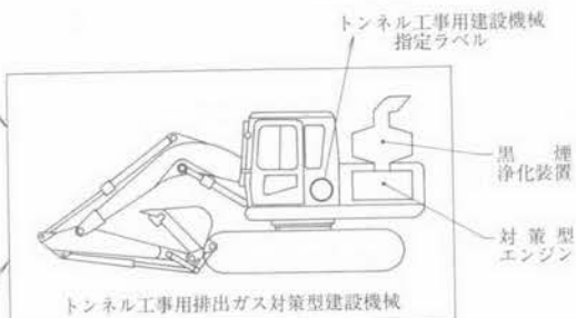
トンネル工事に用排出ガス対策型建設機械
