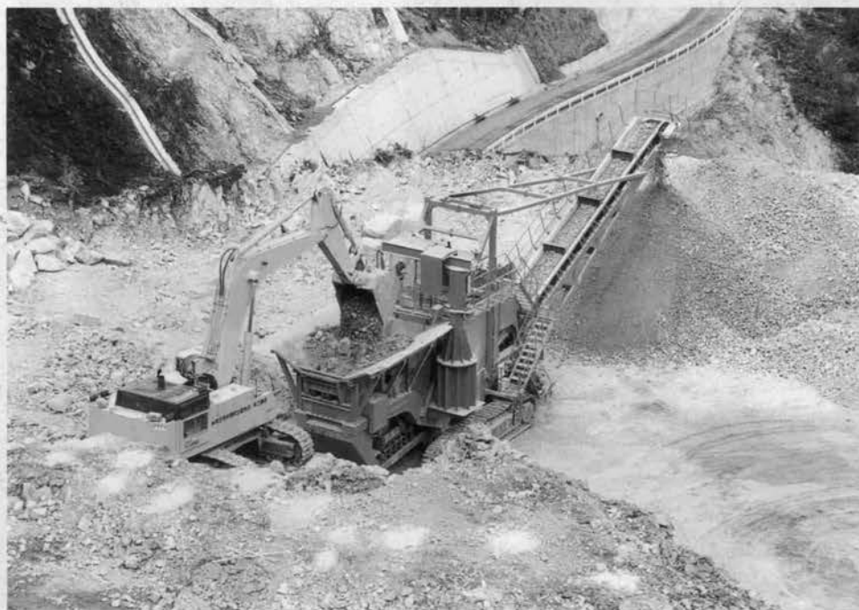
◆ 比奈知ダム 自走式フラッシュヤ (処理能力374t/h, 走行速度15m/min)
