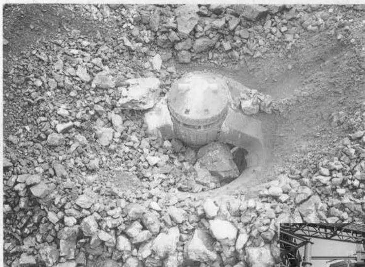
⇨ 日吉ダム ジャイレートリクラッシャ(油圧式) (処理能力630t/h)
