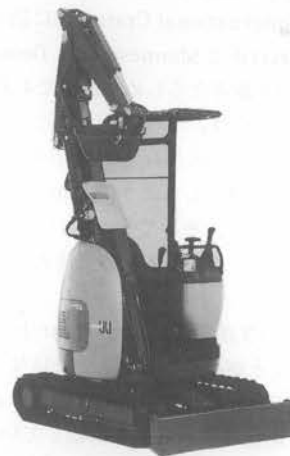
写真-2 コマツ PC08 UU -1 超小旋回式マイクロショベル (ディーゼルエンジン仕様)
