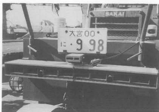
写真-3 トランスポンダ方式のセンサ（上：改良型、下：従来型）
