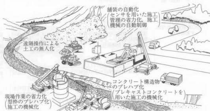
図-4 施工の自動化
