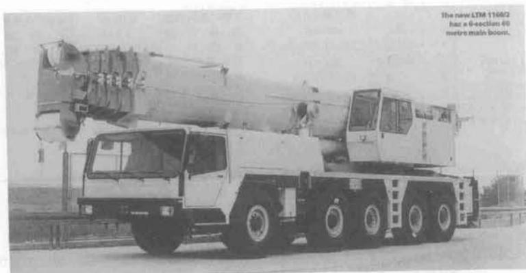
写真-3 ブームの断面形状が卵形 60 m クレーン
