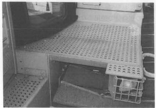
写真-4 打抜き鋼板製ステップ
