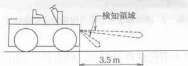
図三 赤外線反射方式の検知領域
