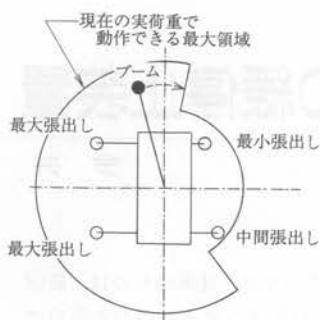
図—2 アウトリガ異張出時の性能模式図
