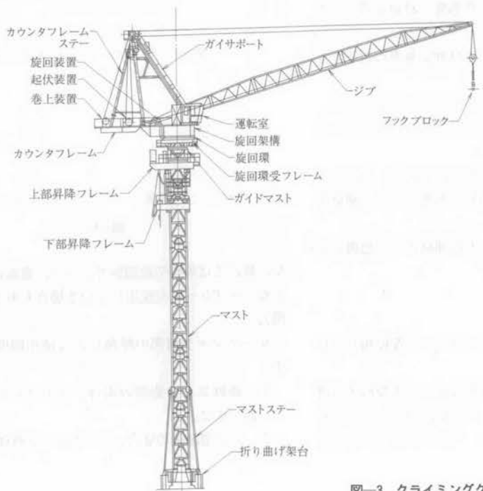
図—3 クライミングクレーン各部の名称
