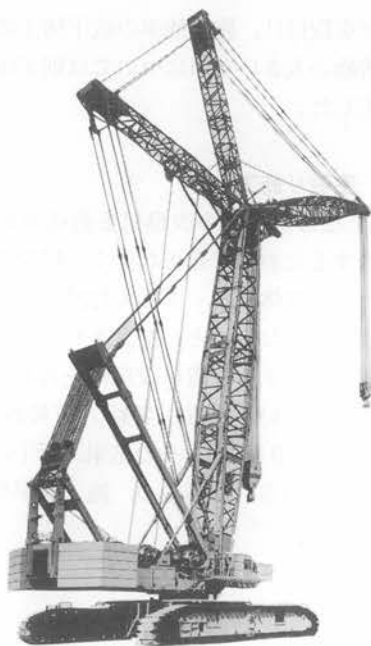
写真-1 650t吊りクローラクレーン
