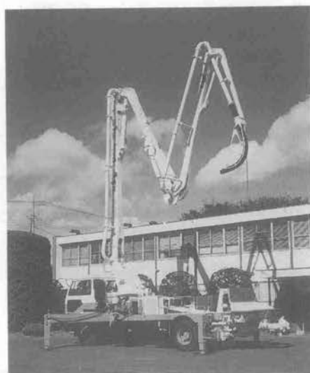
写真-10 ニイガタ URBAN & MC SWING NCP 11 FB-264 コンクリートポンプ車
