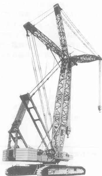
写真7 鉄鋼 7650 クローラークレーン
