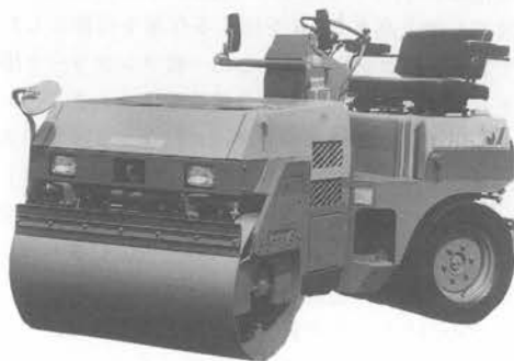
写真—13 コマツ JV 25 CW-2 アーティキュレート式コンパインドローラ
