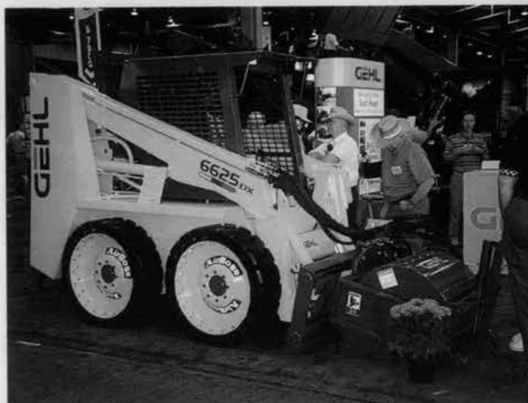
◆ スキットステアローダのアタッチメントとして取付けた道路補修用路面破碎装置
