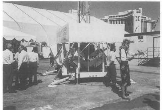
写真一八 折たたみ式照明タワー
