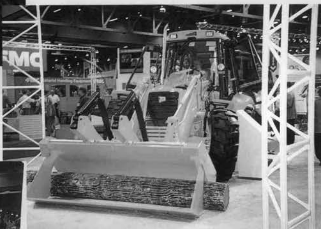
◆ JCBバックホウローダの多用途化フロント上の2本のL型がフォークになっている
