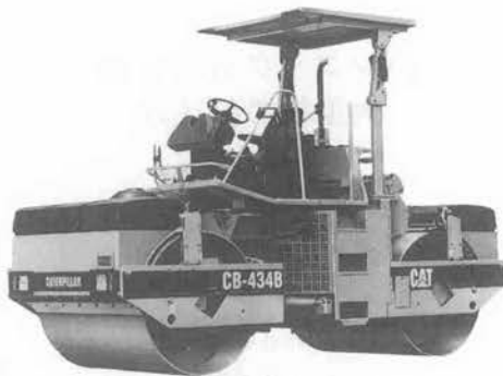
写真—8 CAT CB-434 Bダブルドラム振動ローラ
