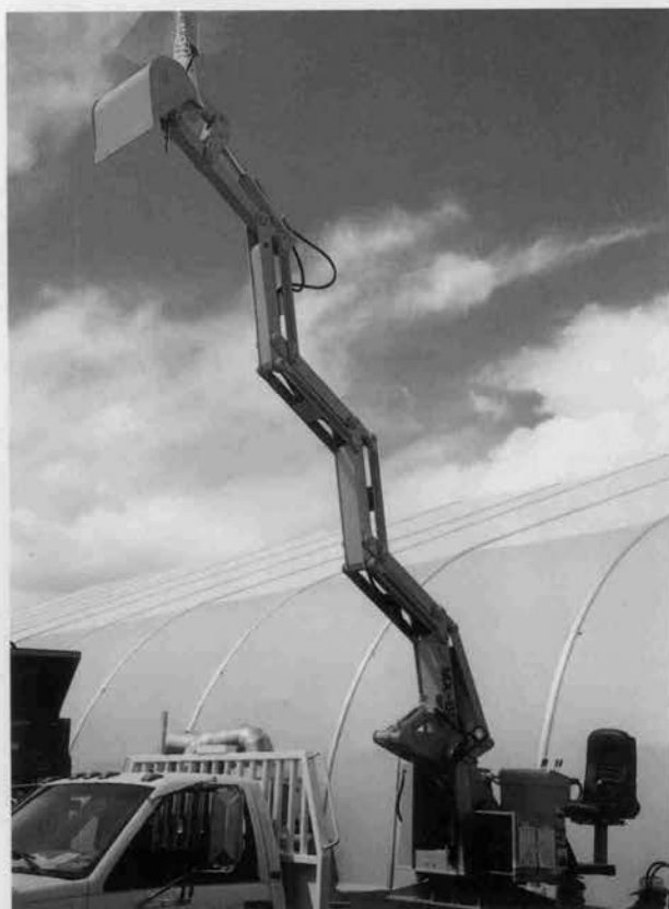
⇨平行リンクを使ったハイリーチ、ハイリフトのス コーピョンショベル
