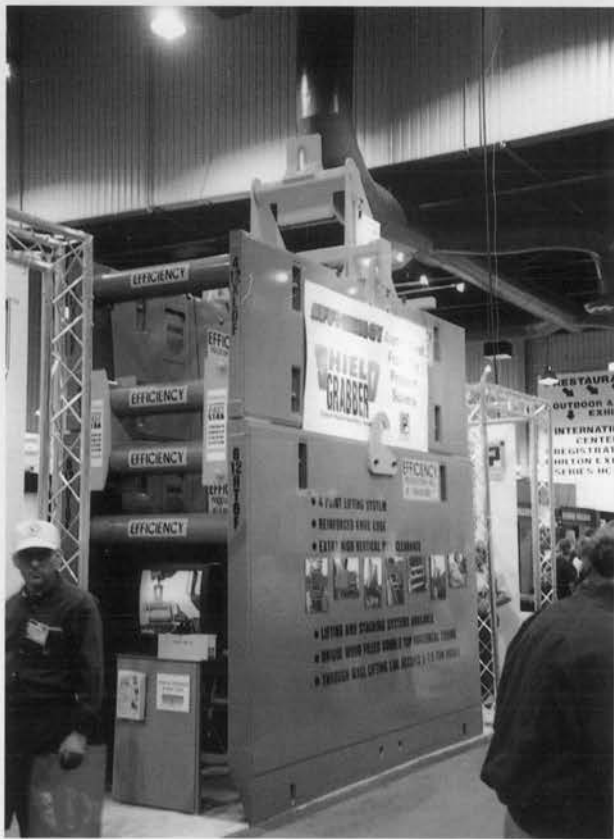
⇨ トレンチシールドの把持装置 (上の黄色い部分)
