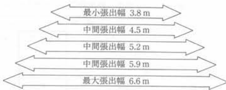
図-4 アウトリガの張出し段数, 張出し幅アップ
