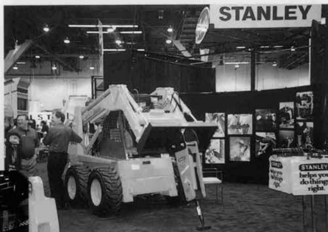
◆ スキットステアローダのアタッチメントとして取付けたコンクリート解体用ハンマー（ブレーカ）
