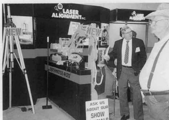
⇨レーザーを使用し、油圧ショベルの自動水平 法面掘削を行うシステムの模型
