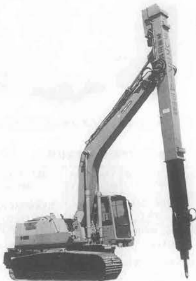
写真-5 レンタルのニッケン 15m 垂直テレスコアーム付油圧ブレーカ
