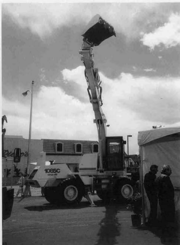
⇨ラフタレンタイプの油圧ショベル
