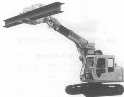
写真-4 日立 EEX 60 LCK 鋼材ハンドリング機
