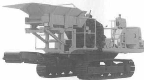
写真-10 コマツ・ガラパゴス BR 100 R 1 自走式破砕機
