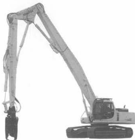
写真-2 コマツ・ニューアバンセ PC 300 LC-6 D 解体ロングフロント仕様油圧ショベル
