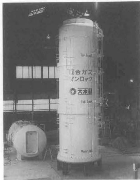
写真-8 混合ガスマンロック挿入
