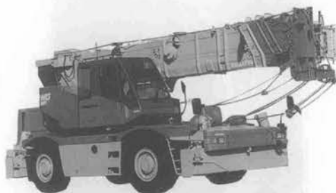
写真-8 コマツ「WING250」LW 250 s ラフテレーンクレーン
