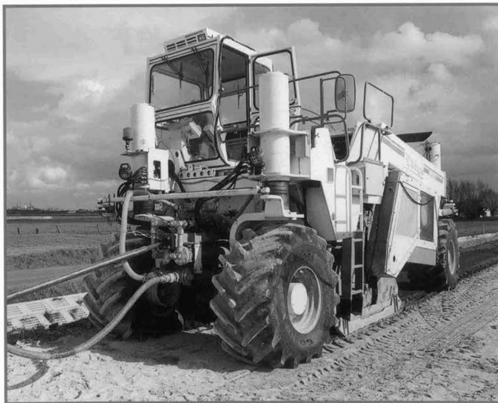
Wirtgen社製 リサイクラー WR 2500 ヴィルトゲン・ジャパン株式会社
