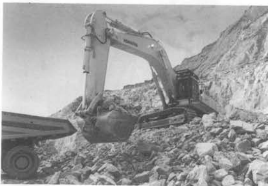
写真-5 コマツニューアバンセ PC 800 g 油圧ショベル
