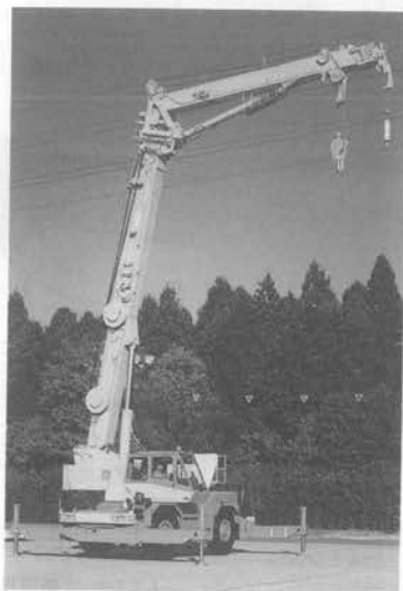
写真-9 コマツ LT 500 1 「ピタガラス」リーチタワークレーン
