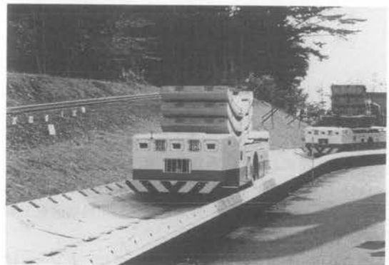
写真-19 タイヤ式坑内自動搬送車
