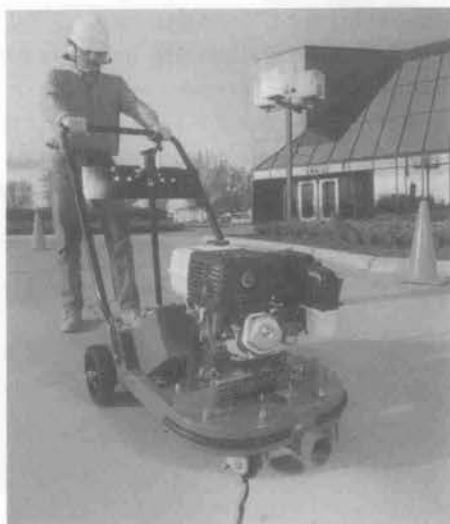
写真一 オペレータは、CS 8 を押すというよりは、むしろ引くので、リヤマウントブレードやクラックがよく見える。ブレードがセンタにあるので、CS 8 がセンタビッド出来る
