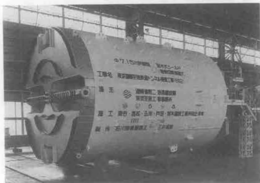
写真—18 ドレーン材対応シールド機械
