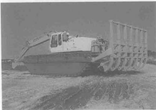
写真—3 作業車（トレンチ用）
