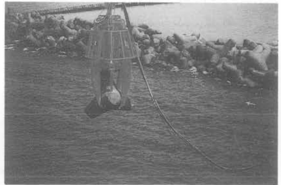
写真-4 グラブ式プロトタイプ機による海上実験
