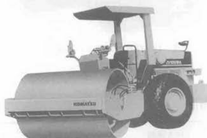
写真-12 コマツ JV 100 WA 大型振動ローラ
