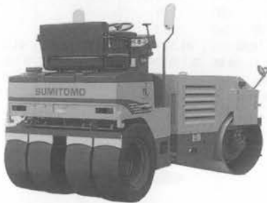
写真-13 住友 HW 30 VW 振動ローラ
