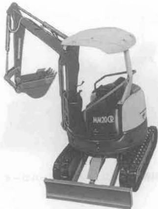
写真-3 三菱 MM 20 CR 後方小旋回式ミニ油圧ショベル
