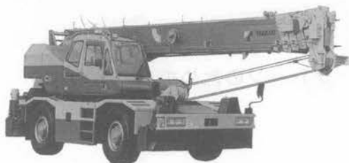
写真-9 タダノ CREVO 250 (TR-250 M) ラフテレーンクレーン
