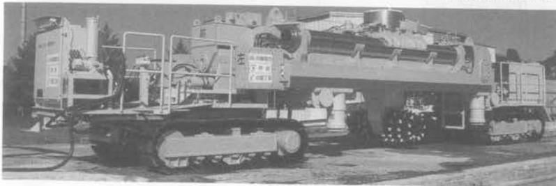
写真-1 インバート切削ロボット
