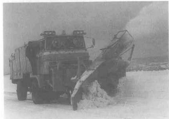
写真—2 性能試験中のSR 300型高速ロータリ除雪車
