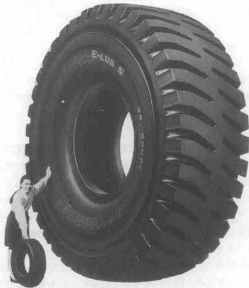
写真—2 下関工場で生産する世界最大のダンプトラック用タイヤ(タイヤサイズ:48/95 R57)
