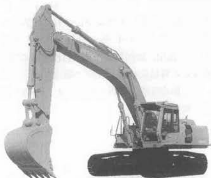
写真-5 日立 EX 450 H-3c 大型油圧ショベル
