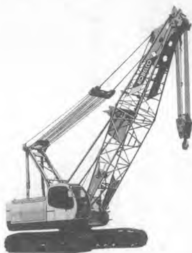
写真-11 神鋼マスターテック 7050 クローラクレーン
