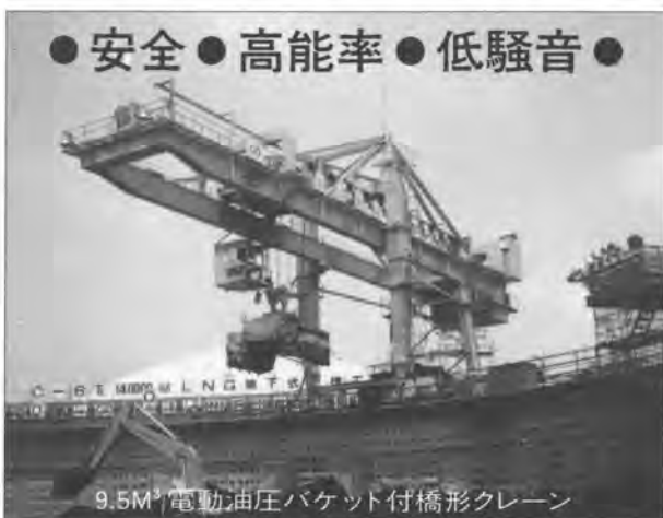
9.5M 3 電動油圧バケット付橋形クレーン YGMT-10H-400 巻上速度 70m/min 横行速度 70m/min 走行速度 8m/min
