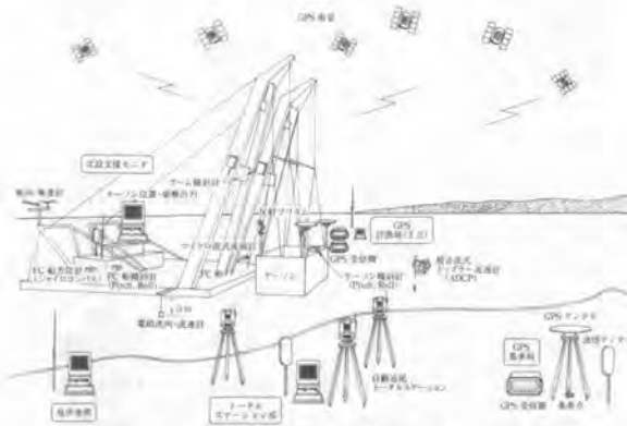
図一1 ケーソンの設置計測への適用
