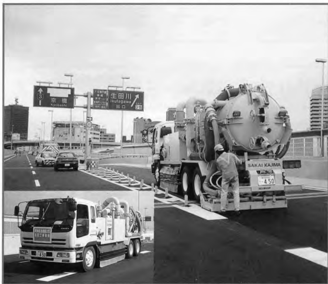
排水性舗装機能回復車 クリーンジェットCJ400 酒井重工業株式会社
