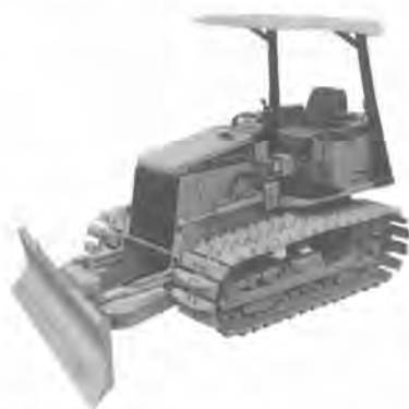
写真1 三菱 BD 2H (E) ブルドーザ (湿地車)
