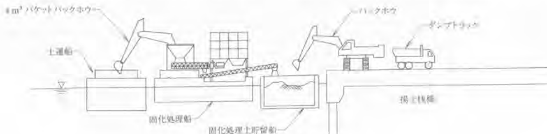
図-6 固化処理設備
