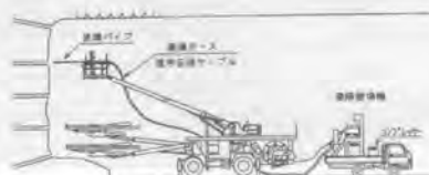
図-2 遠隔装填システム全体図
