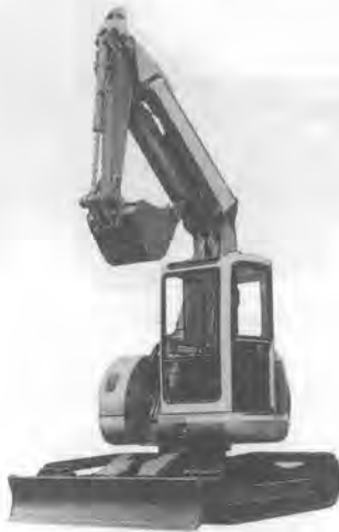
写真-3 神鋼 SK 75 UR 油圧ショベル
