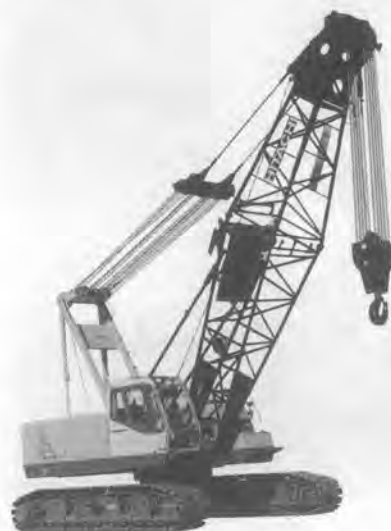
写真-8 日立 CX 650 クローラクレーン
