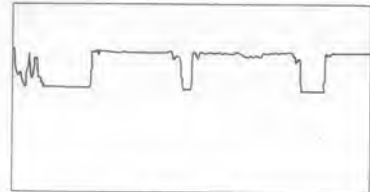
＜砂岩層＞ 砂利（転石）混りの為細かい電圧変動
