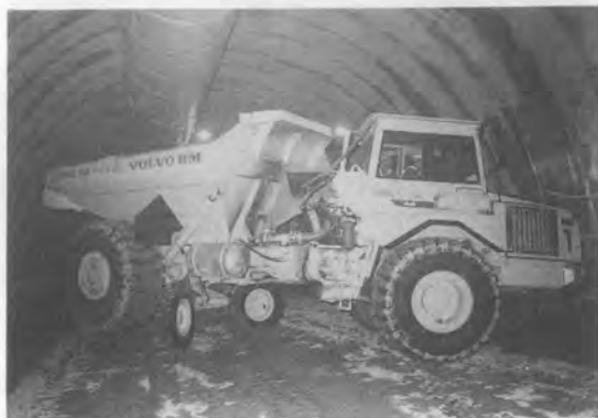
重ダンプトラック (方向転換機能付き)
