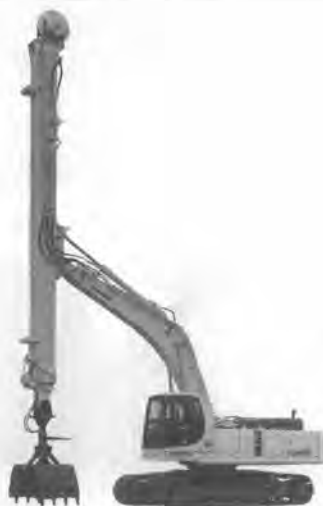
写真-4 コマツ PC 300 SCs テレスコピッククラムシェル仕様油圧ショベル
