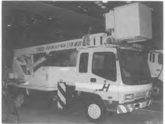
写真-5 高所作業車
