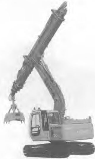
写真-2 日立油圧ショベル用・無線式リモコンシステム (EX 120 s テレスコピックコラムシェル搭載例)
