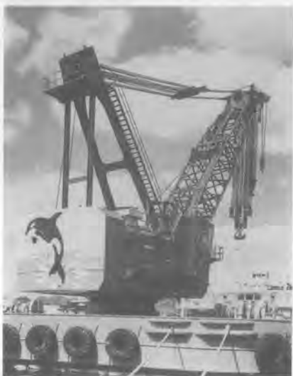
写真-7 神戸 F & 3516 クレーン・グラブ兼用大型作業船
