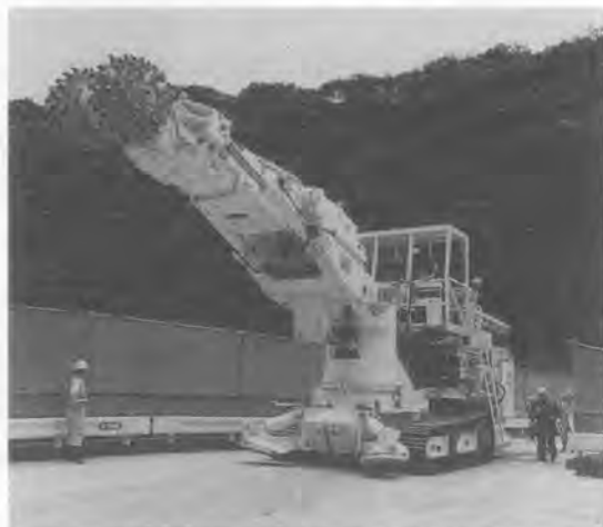
写真-6 ウェストファリアアタイクウ WAV 300 H パワーカッタ
