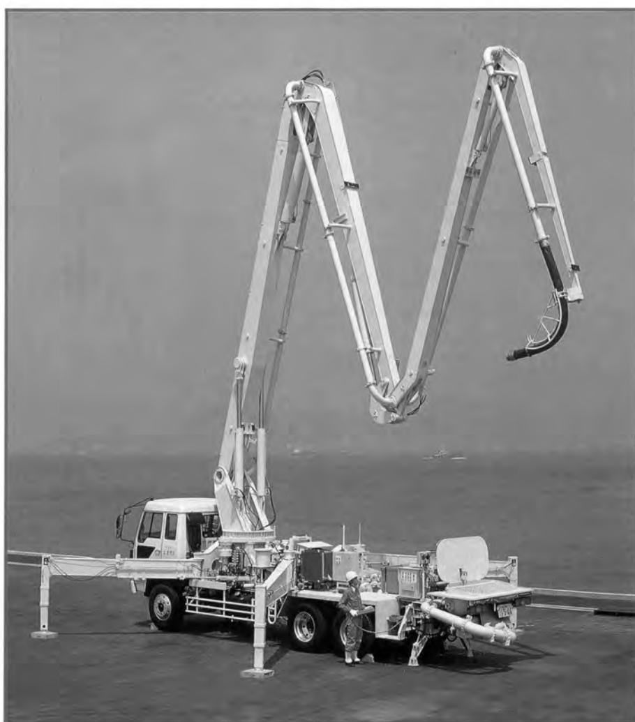
コンクリートポンプ車 ダイヤクリートL 1100BD-M33型 三菱重工業株式会社
