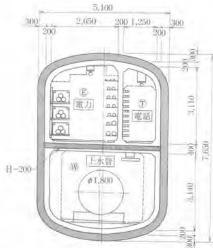
図-2 共同溝縦断面図
