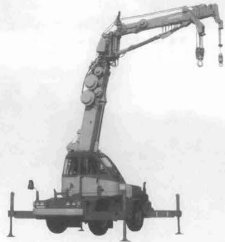
写真—12 リーチタワークレーン (LT 300 ピタゴラス)
