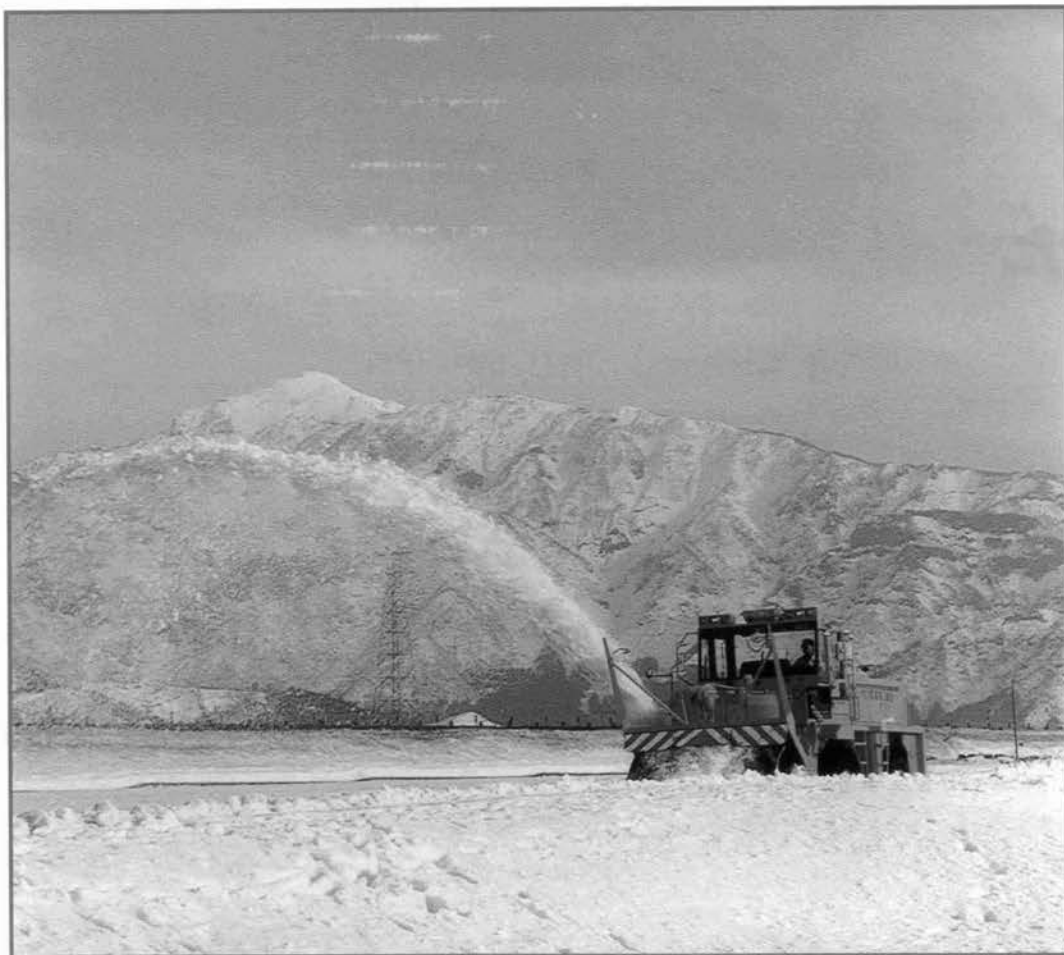
ロータリ除雪車 (400PS級, ツーステージ式, R400形) 東洋運搬機株式会社
