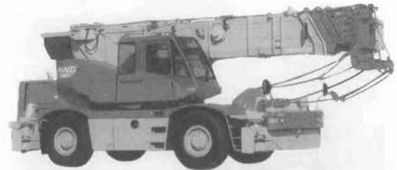
写真—11 ラフテレンクレーン (Wing 250)
