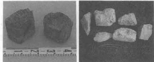
写真-5 (a) シールド機に取り込まれた切断ブロック 写真-5 (b) シールド機に取り込まれた切断ブロック
