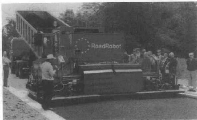
写真 RoadRobot による道路舗装テスト、施工幅 6 m
