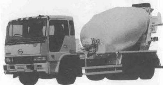
写真12 日野スーパードルフィン・プロフィア L22 シリーズ KC-FS 2 KPDA トラックミキサ
