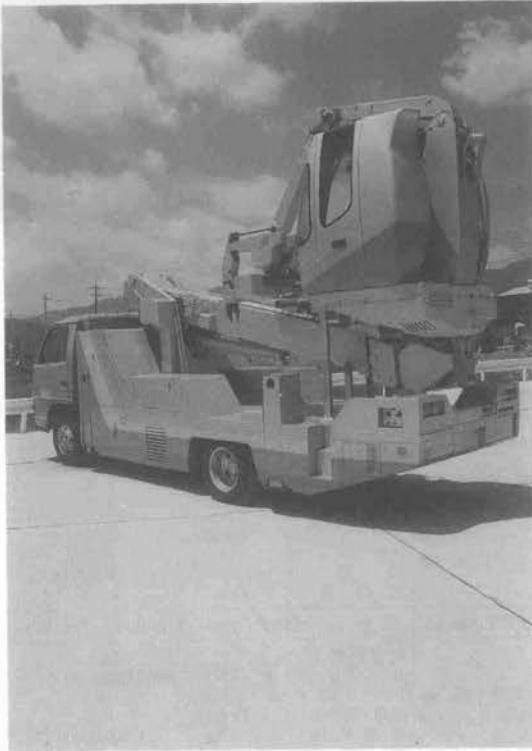
写真—5 配電ロボット車 (U-276)
