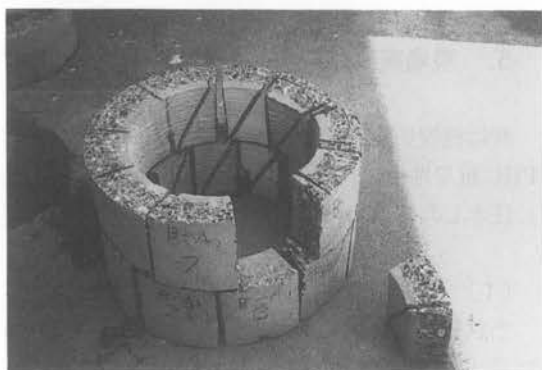
写真—3 現場実証実験における切断ブロック
