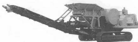
写真11 コマツ・ガラバゴス BR 100 JG 1 自走式破砕機（振動グリズリフィーダ搭載車）
