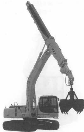
写真-4 コマツ・ニューアバンセ PC 200 SC 6 スーパーテレスコクラム（スライドキャブ仕様）
