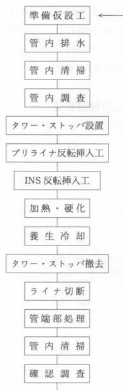
図-2 施工フロー
