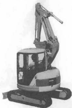
写真1 コマツ・アバンセ UU・PC 50 UU-2E 超小旋回型小型油圧ショベル
