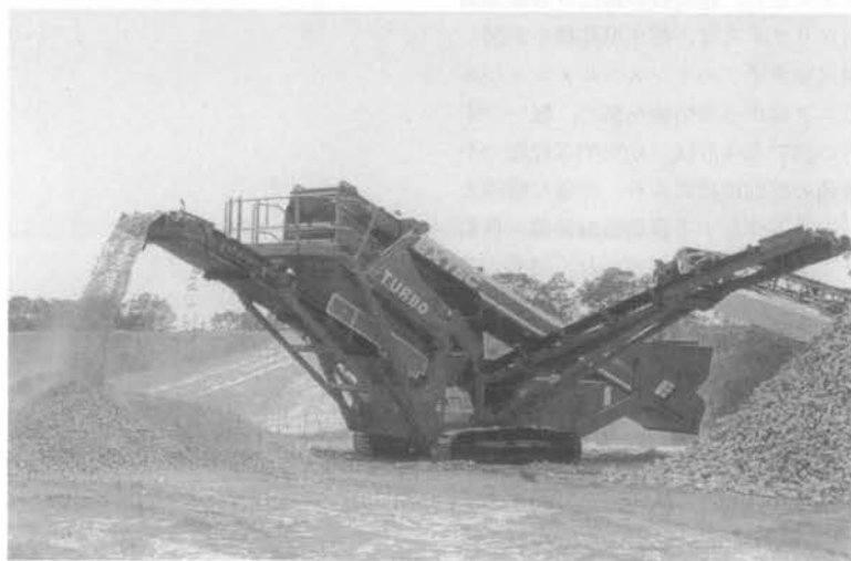
写真—1 Extec 社の三方向ストック機能をもつ新骨材生産ユニット
