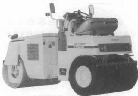
写真-14 川崎オーセントKV4WAアーティキュレート式振動ローラ
