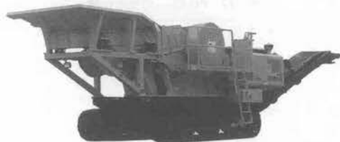
写真9 コマツ・ガラバゴス BR 350 JG 1 移動式破砕機
