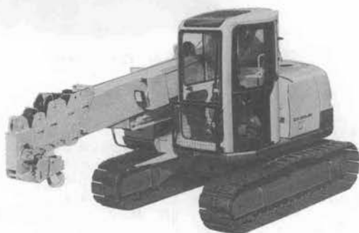
写真-10 神鋼 CK 90 UR 小型クローラークレーン
