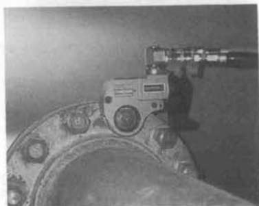
図-3 油圧トルクレンチの使用例
