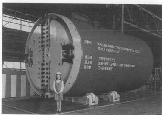
写真-1 受入側(2工区)シールド機
