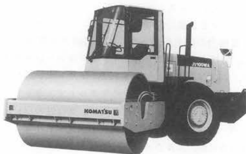
写真-12 コマツ JV 100 WA 2 振動ローラ
