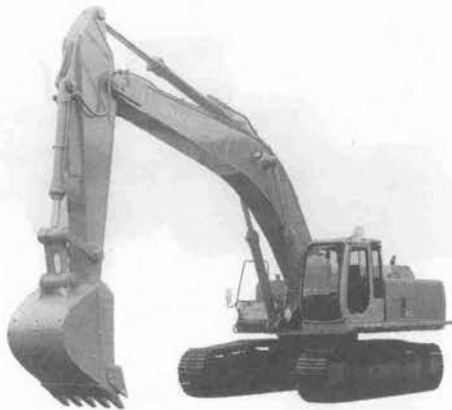
写真-5 日立 EX 400 s 大型油圧ショベル
