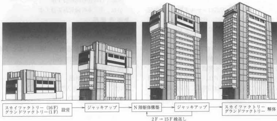
図-2 全体施工プロセス
