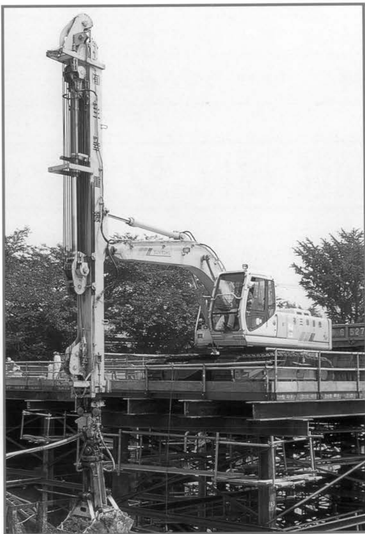
深礎立坑掘削用「パイプクラム®」SH200LPC 住友建機株式会社
