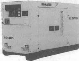
写真11 コマツ EG 45 BS-1ディーゼル発電機
