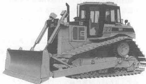
写真1 CAT D6R 湿地ブルドーザ
