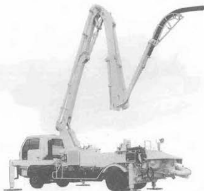
写真8 新潟 NCP 7 FB コンクリートポンプ車
