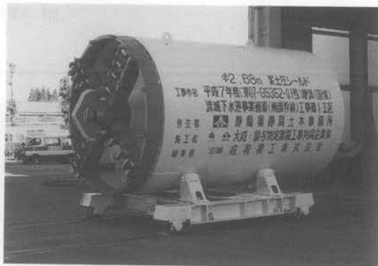
写真—3 φ2.68m 泥土圧シールド
