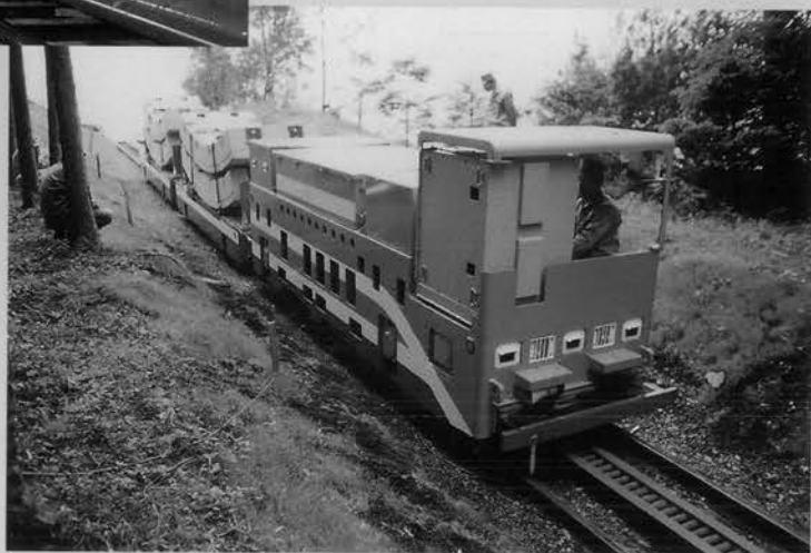
↓バッテリー機関車 20%急勾配走行試験
