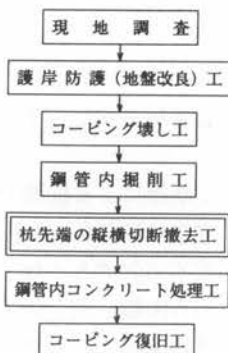
図-3 鋼管杭撤去工事の施工フロー
