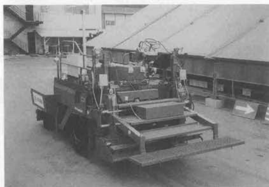
写真-30 オフレール式薄層コンクリートフィニッシャ
