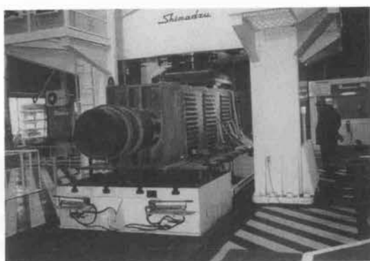
写真1 箱桁部性能確認試験
