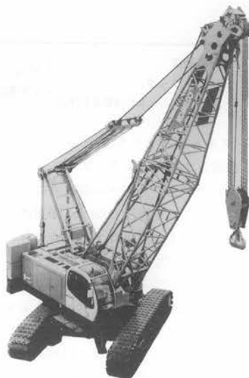
写真-7 神戸・マスターテック 7080 2 クローラクレーン
