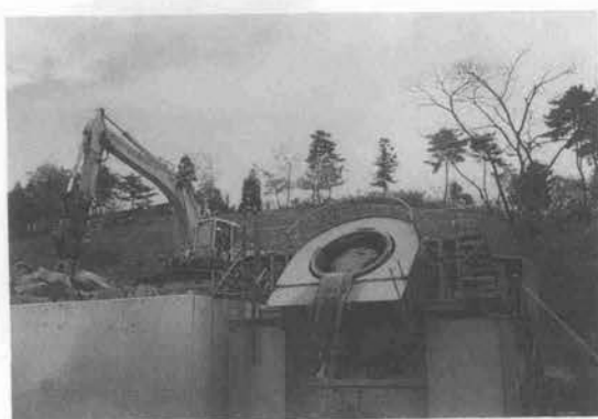
写真-9 コマツ SG-15-23「大玉ころころ」自然石製造機
