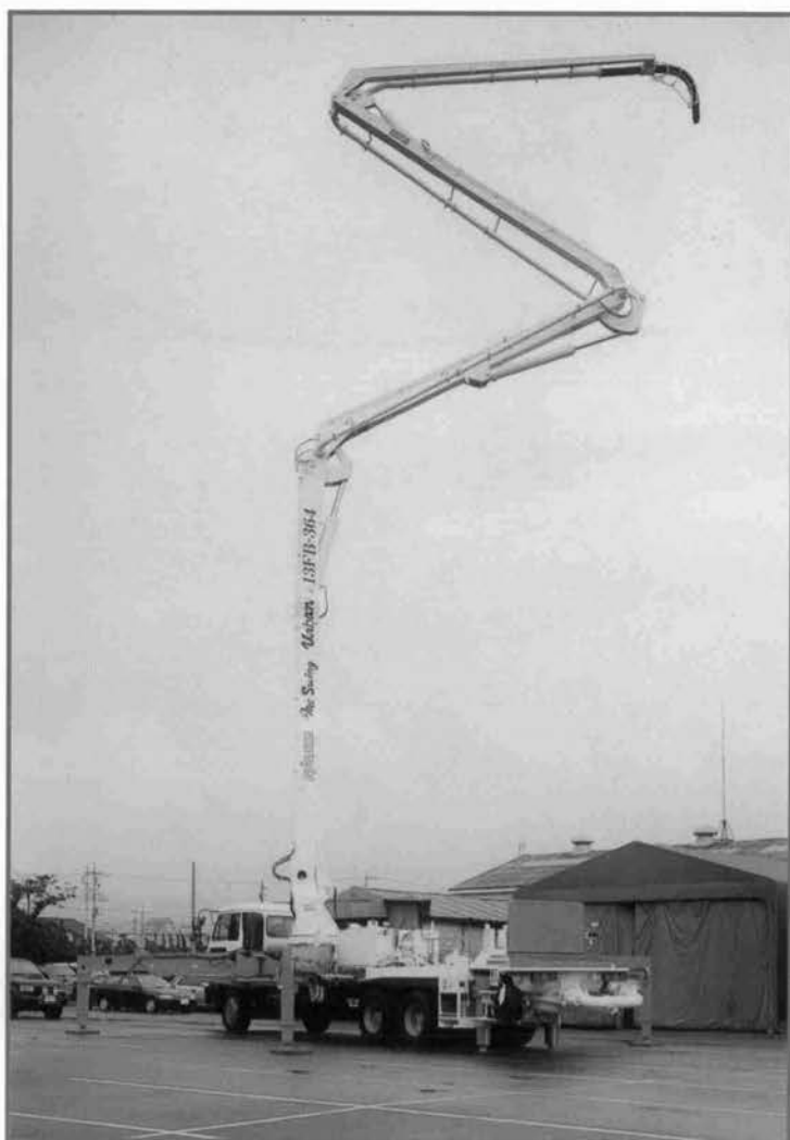
コンクリートポンプ車「NCP13FB-364」 株式会社 新潟鉄工所
