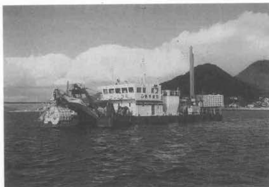
写真—38 高濃度底泥浚渫船「カレン3号」
