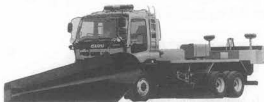
写真—12 いすゞ GIGA・KC-CYW 82 Q 2 (改) 除雪車 (6×6)
