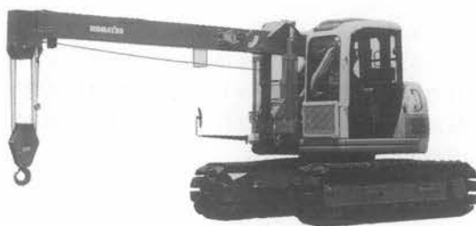
写真-6 コマツ LC 1285 テレスコピック式クローラクレーン
