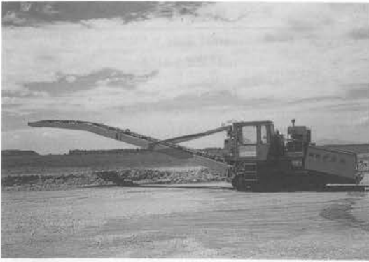
写真-3 材料供給用大型スイングフィーダ
