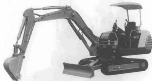
写真-2 三菱 MM 30 T ミニ油圧ショベル
