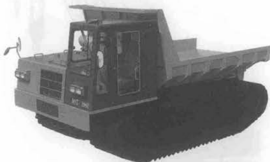
写真-10 コマツ MST 2000-3A ゴムクローラキャリヤ
