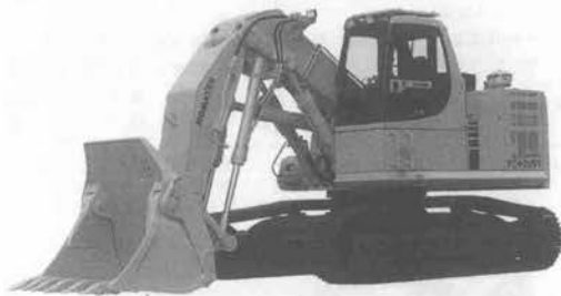
写真-6 (1) コマツ PC 400 ST トンネル工専用油圧ショベル (ローダ仕様)
