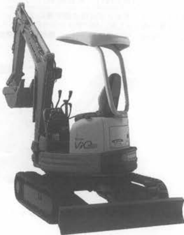
写真—3 ヤンマー Surer Vio 20 後方小旋回型ミニショベル
