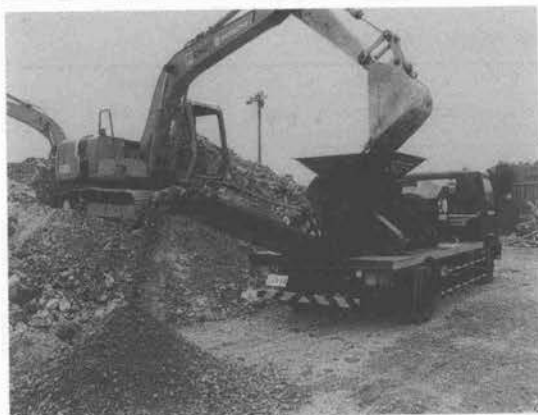
写真-11 オカダアイオン DRC-25 TR「割ッ太郎カー」4軸ロールトラッククラッシャー
