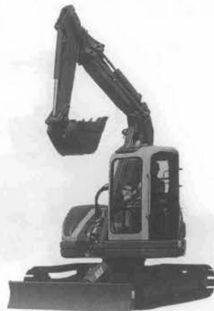
写真-4 コマツ・アバンセ UU・PC 75 UU 3 超小旋回型油圧ショベル
