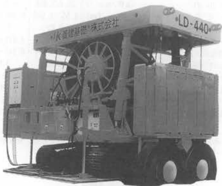
写真—10 菱建基礎・鉦研工業 LD-440 連続地中壁掘削機
