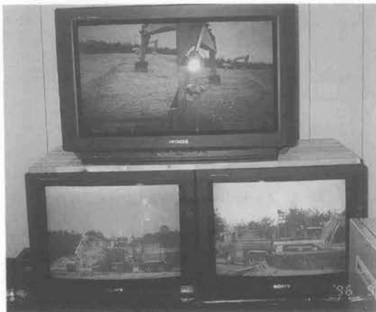
写真-1 操作室内のTV映像状況
