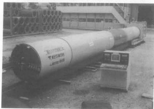
写真一1 ライニング打設実験
