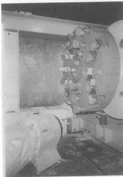
写真-8 ラップ切削実験状況
