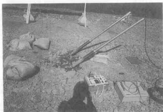
写真-3 2孔式 RI 計器による計測状況
