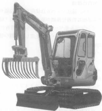
写真-5 蓮根掘り仕様機「蓮根掘」
