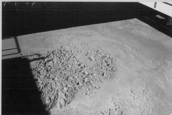
↓処理前の建設汚泥
