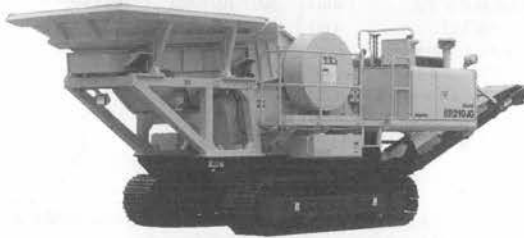
写真-7 コマツ・ガラバゴス BR 210 JG -1 グリズリフィーダ仕様モービルクラッシャー
