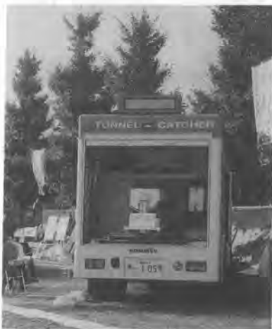
写真一3 トンネルクラック調査車
