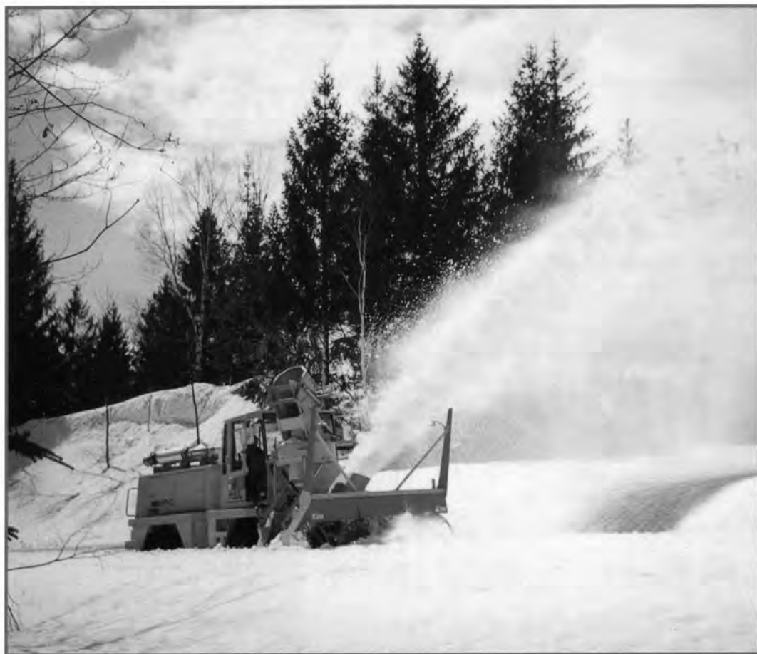
ロータリ除雪車(600PS級, ツーステージ式, R600形) 東洋運搬機株式会社
