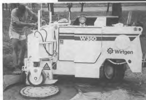
マンホールの周りも簡単に切削できます
