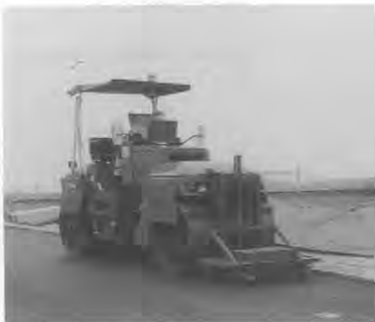
写真-2 締固め自動制御型ローラ
