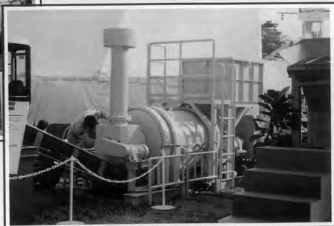
↑汚泥改質固化処理装置
