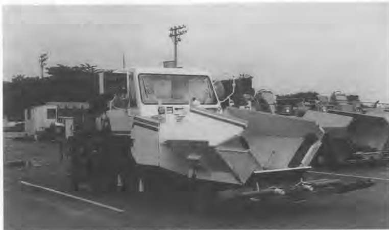
写真-1 ロボットアスファルトフィニッシャ
