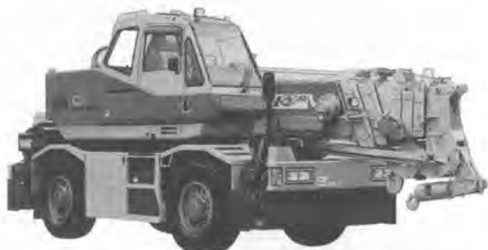
写真-7 タダノ CREVO 160 (TR-160 M) ラフテレーンクレーン
