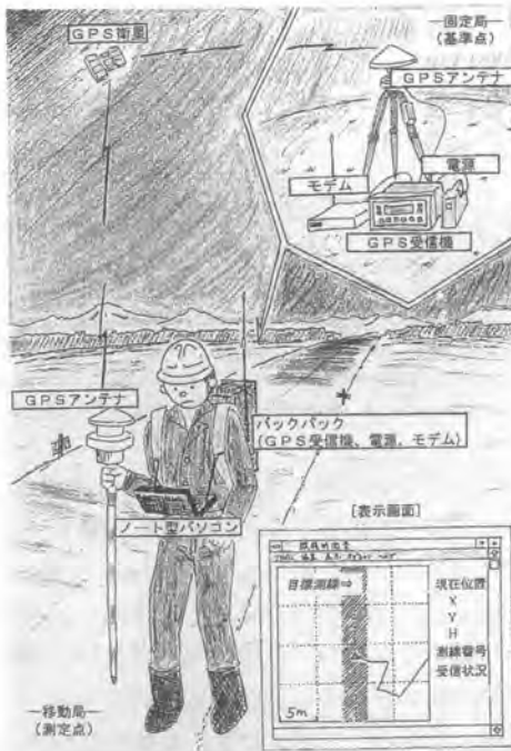
図-1 工事測量のシステム
