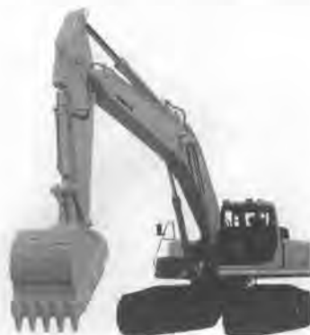
写真-2 コマツ・パワーアバンセ PC 450- s 油圧ショベル (碎石仕様車)
