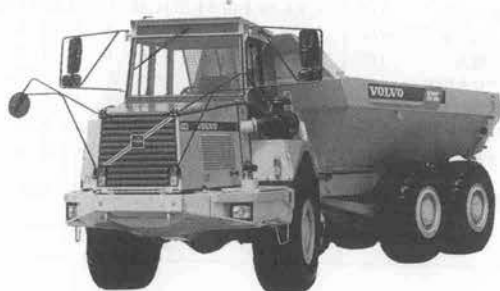
写真-4 日立・ボルボ A 20 C 6×6 アーティキュレートダンプトラック
