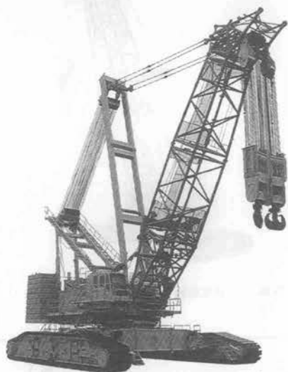
写真-5 住友 CT 15000 全油圧式超大型クローラクレーン
