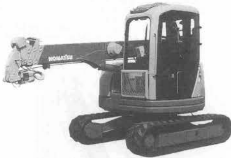
写真-7 コマツ LC 503 テレスコピック式クローラクレーン
