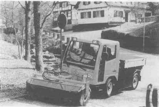
写真—13 (2) ベンツ・ウニモグ UX 100 M 多目的作業車 (フロントスワイパ装備)
