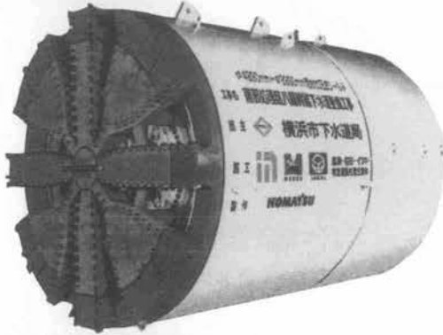
Sシールド離脱発進時
