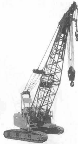
写真-8 日本車輛 DH 500- g クローラクレーン
