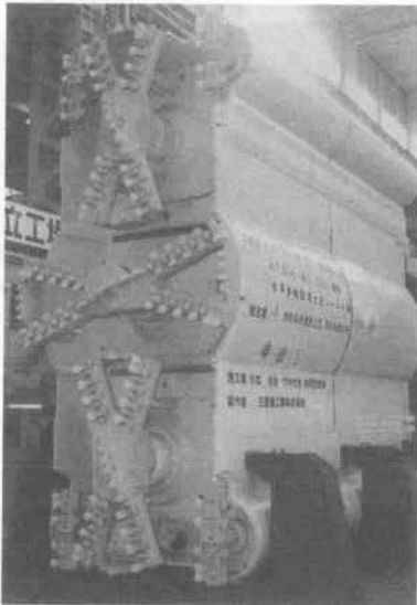
写真-3 泥土圧式 MMST シールド機
