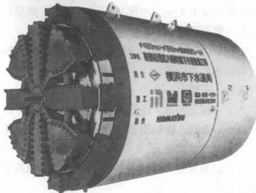
写真一1 φ4,930 mmのMSシールド機（上）と子機の発進状況（下）
