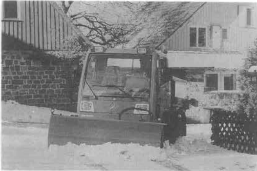
写真—13 (1) ベンツ・ウニモグ UX 100 H 多目的作業車 (スノーブ劳装備)
