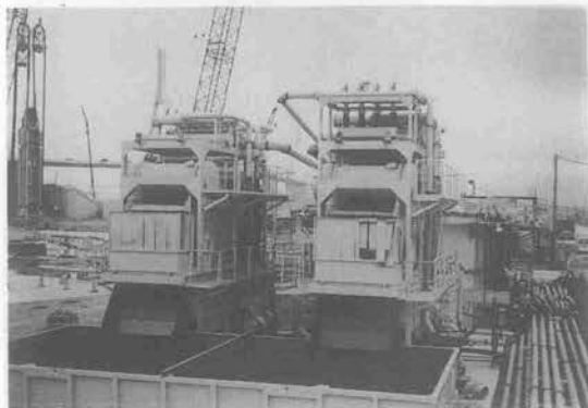
写真-4 サイクロンスクリーン 左：MD-6×20本（BC用），8 m 3 /min；右：MD-6×24本（HF用），10m 3 /min
