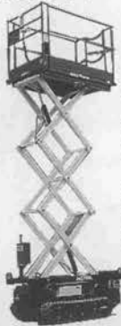
CL-610 作業高さ：8.00m 作業台高さ：6.00m
