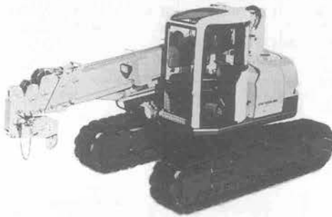
写真-5 神鋼 CK 120 UR クローラクレーン
