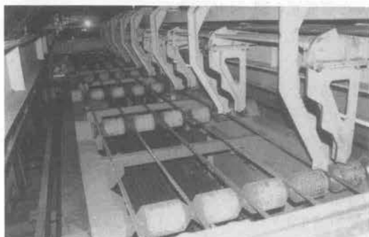
写真-3 配力筋送出し装置
