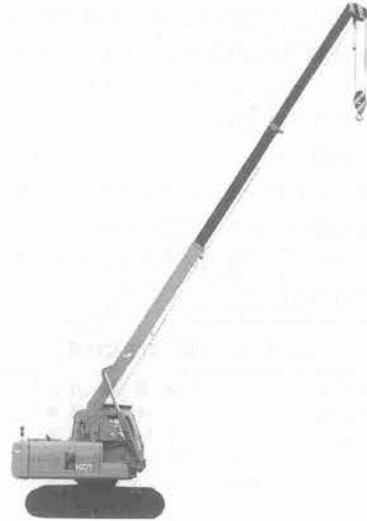
写真-6 日立 EX 100 T テレスコピッククローラクレーン
