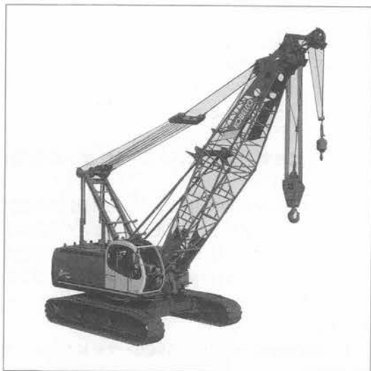
写真-3 クローラクレーン(マスターテック7055-2)
