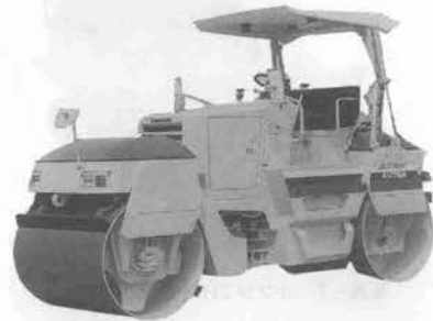
写真-6 川崎重工業 KV 7 SA 振動ローラ (アーティキュレート式)
