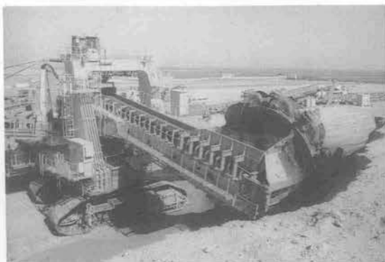
写真-5 土取B地区バケットホイールエキスカベータ掘削状況
