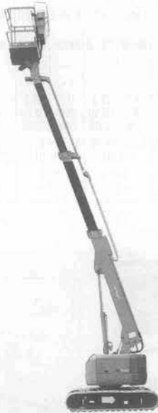
写真-5 日立 HX 99 B 高所作業車 (クローラ式)
