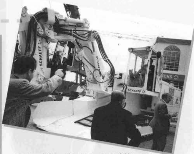
⇨Schaeff社（ドイツ）の多機能マシン （ブレーカ、バケット、排出コンベヤ付）
