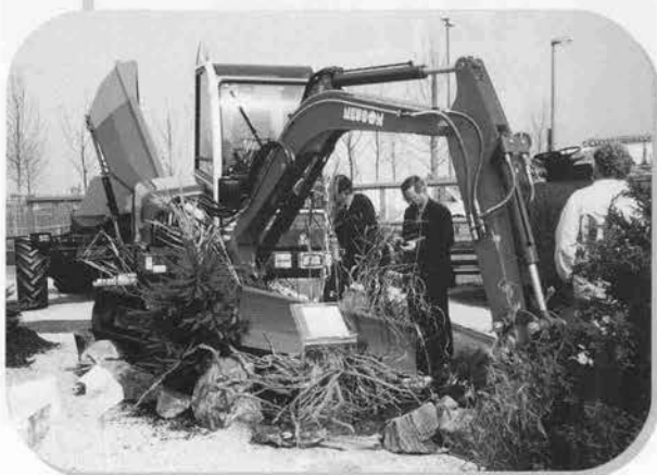
⇨Neuson社（ドイツ）の 足回り揺動ミニバックホウ
