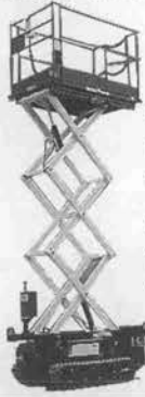
CL-610 作業高さ：8.00m 作業台高さ：6.00m
