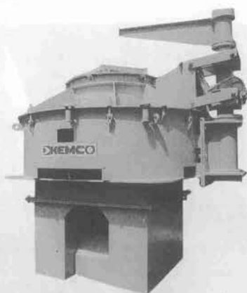
写真-3 堅型回転式遠心碎塊装置 パーマックインパクト (BM 2000)
