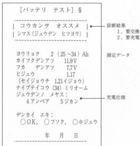
図-5 印字例 (不良診断結果)
