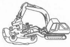
⑥ 車輦部をクランプアームで押さえて、ニブラで折曲げて切断す。
