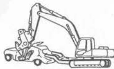
② クランプアームで車を縦方向に押さえ、シートを引きちぎり仕分け位置に置く。
