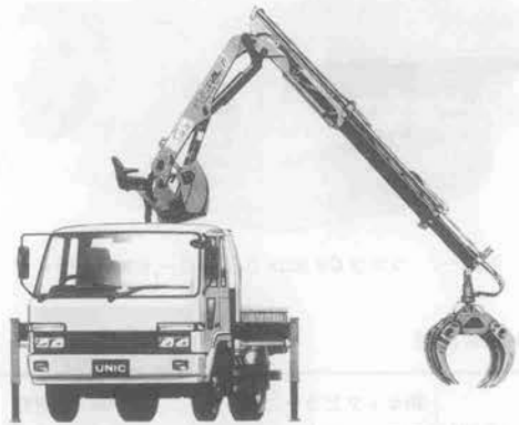
写真-6 古河ユニック PK-9001 AH 4 トラック搭載型クレーン (ユニックバル)
