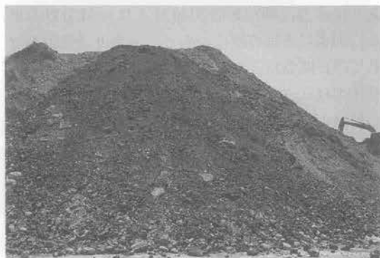
写真-3 発生路盤材
