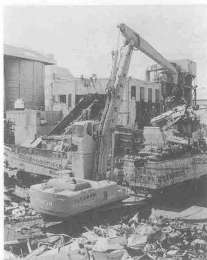
写真—8 EX 220 LC スクラップ仕様機
