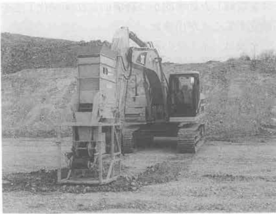
写真7 0.7 m 3 バックホウをベースマシンとしたアタッチメント方式の吹付施工機械
