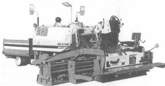
写真一八 三菱 MF 41 WD アスファルトフィニッシャー
