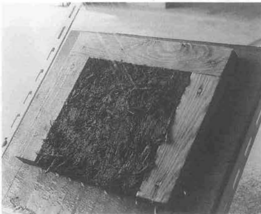
写真—2 降雨実験状況(傾斜45度)
