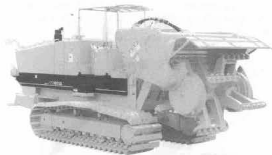
写真一七 コマツ CS 360S D-2 A ロードスタビライザ
