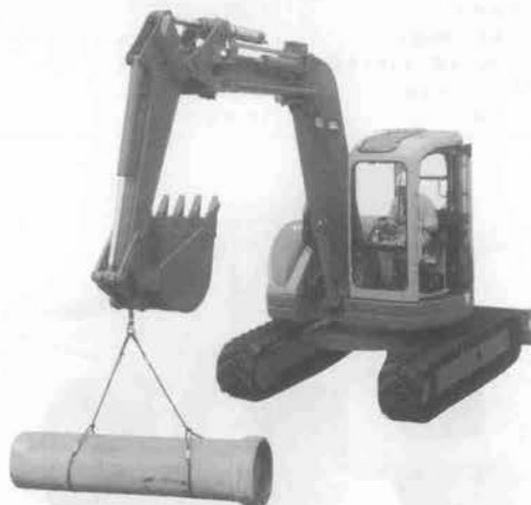
写真-2 コマツ PC75UU-3 油圧ショベル (デジタル式アームクレーン仕様) (ゴムクローラ、全格納フック付)
