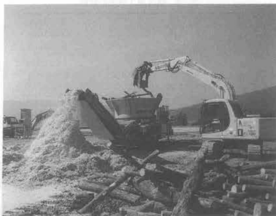
写真—4 タブグラインダによる粉砕処理 全重量：16.7 t、全長11 m、破砕能力：36~72 m 3 /h
