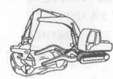
⑧ エンジン、ミッションサポートを切断する。
