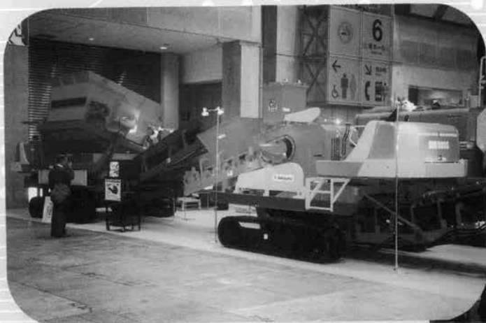
↑自走式混合解碎機と選別機 〈(株)中山鉄工所〉
