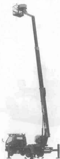
写真-5 アイチ SJ-16 A (スカイマスター) 高所作業車
