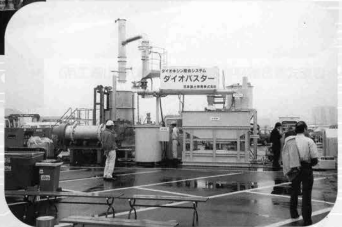
↑ 小型焼却炉対象のダイオキシン除去システム 「ダイオバスター」 (日本国土開発(株))
