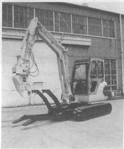
写真—4 EX 45 廃家電処理機
