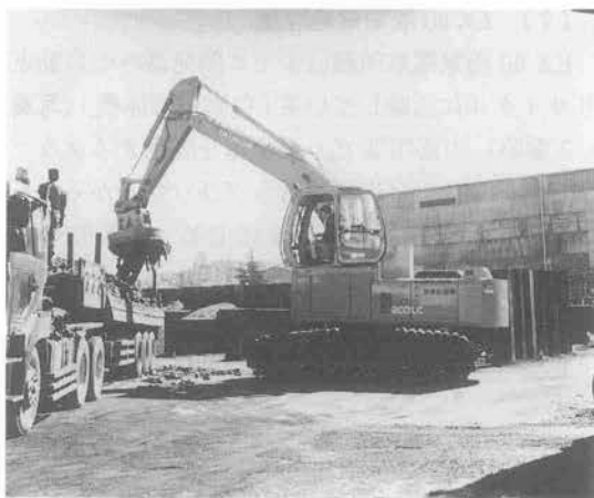
写真—5 EX 200 LC リフティングマグネット仕様機
