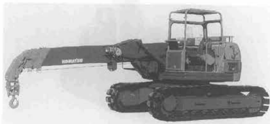
写真—4 コマツLC1285クローラクレーン（地下仕様車）
