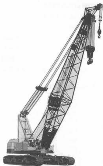
写真-5 日立 CX 1800 クローラクレーン
