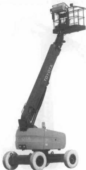
写真-5 高所作業車
