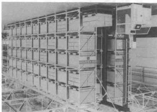
写真-6 ユニット式自動倉庫
